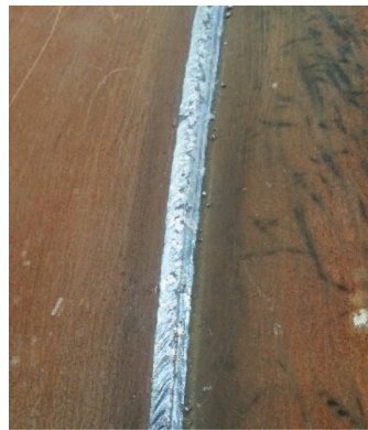
Рис. 12. Обратный валик корневого шва при орбитальной лазерно-дуговой сварке. Зазор 2 мм, вертикальное смещение кромок 3 мм.
