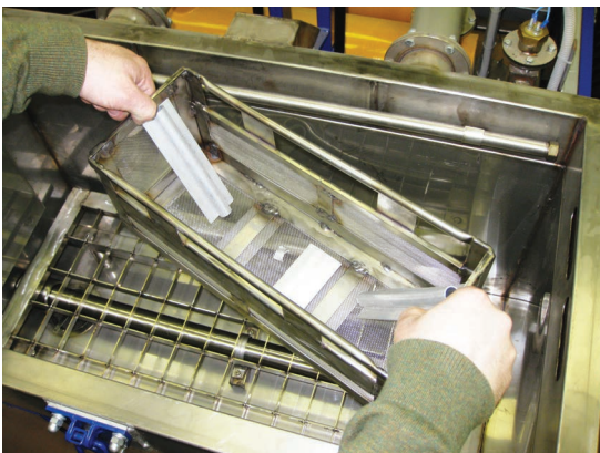
Рис. 14. Загрузка образцов в технологическую корзину установки МР-150.
