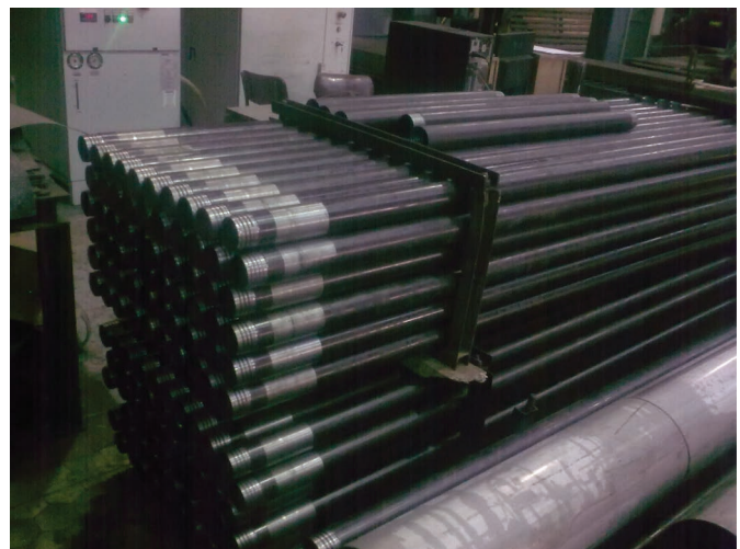
Рис. 13. Трубы после лазерного упрочнения из стали 38ХМН, готовые к отправке.
