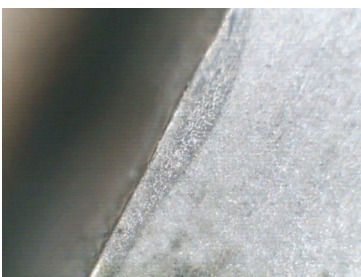
Рис. 10. Вид зоны упрочнения, полученный на стали 32 ГСФ под углом 30°.
