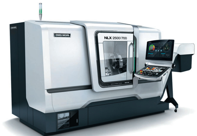
6-осевая обработка благодаря главному шпинделю и протившпинделю и револьверу с ходом в 100 мм по оси Y
