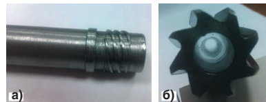
Рис. 2. Доработка развертки для возможности использования на станке для глубокого сверления: а) хвостовик с резьбовым соединением для крепления в сверлильном стебле; б) сквозное отверстие для обработки по принципу одноштанговой системы (STS).
