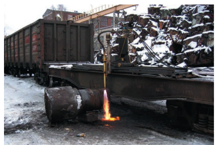
Рис. 3. Резка валов большого диаметра 650–1100 мм на металлургическом заводе «Петросталь».
