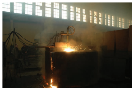
Рис. 2. Резка металла в лом толщиной до 1350 мм.
