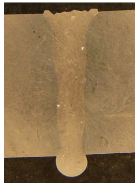
Рис. 13. Макрошлиф гибридного шва алюминиевого сплава AMg6 толщиной 10 мм и распределение магния в сварном соединении.
