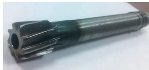
Рис. 1. Развертка, использовавшаяся при обработке глубокого отверстия.
