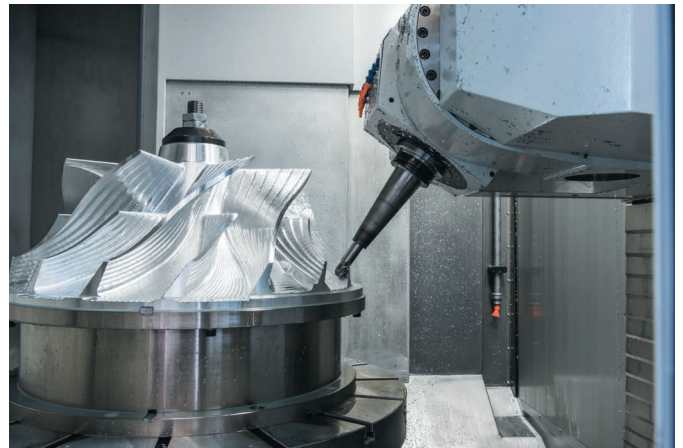
Пример приспособления, разработанного ф. Starrag Обработка импеллера на обрабатывающем центре Starrag мод. STC 800
