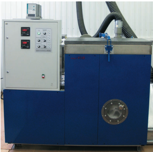
Рис. 13. Автоматизированный цикл очистки образцов в установке МР-150.
