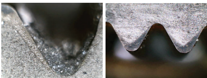
Рис. 12. Зона упрочнения на резьбе стали 32 ГСФ, полученной на режиме 2 кВт, скорость 200 мм/с, диаметр луча 4 мм.
