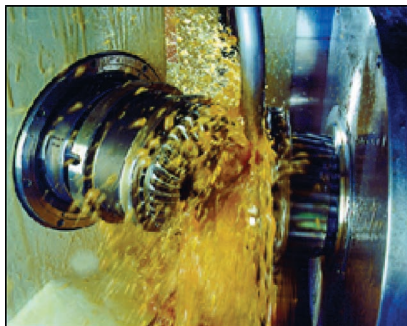
Рис. 1. Фрезерование с применением СОЖ с помощью инструментов из высококачественной быстрорежущей стали.
