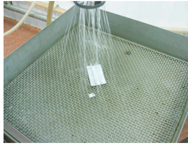
Рис. 5. Орошение образцов фильтрованной водой.
