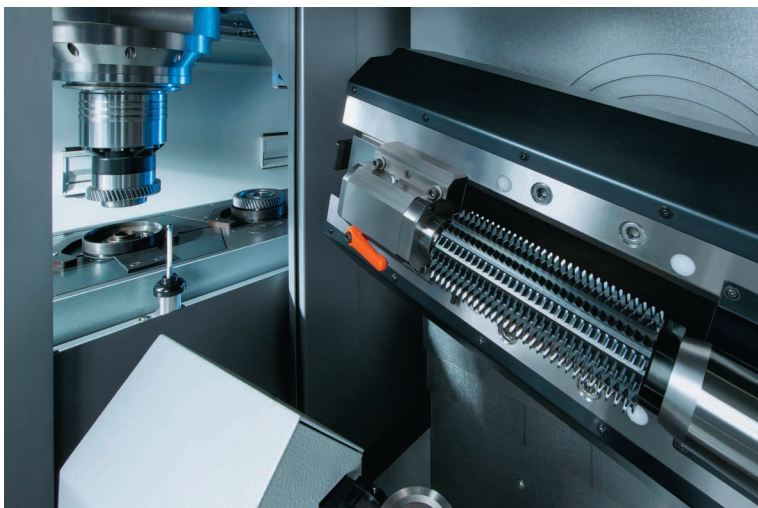
Загрузка заготовок и выгрузка обработанных деталей осуществляется «Pick-Up» — шпинделем. При зубофрезеровании эта хорошо продуманная система обеспечивает увеличение производительности за счет типичной для станков EMAG конструкции.
