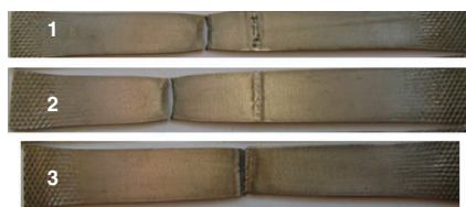
Рис. 3. Образцы сварных соединений стали 12X18H9T после испытаний на разрыв; 1, 2 — модифицированные нанопорошками: 1 — TiN (0,02\%) + Y_2O_3 (0,02\%) + Ti + Fe ; 2 — TiN (0,04\%) + Y_2O_3 (0,04\%) + Ti + Fe ; 3 — без наномодификатора.
