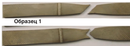
Рис. 4. Образцы сварных соединений титанового сплава после испытаний на разрыв.
