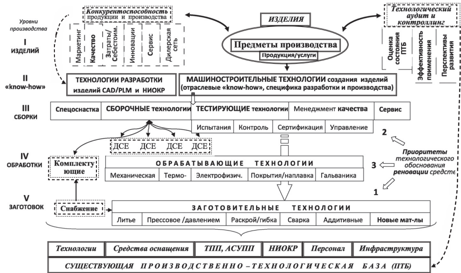
Рис. 1. Приоритетность взаимосвязей средств оснащения производственных переделов машиностроения при выборе эффективных решений при реновации и реинжиниринге.
