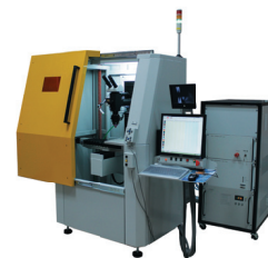
МЛК4-1,2 Импульсный Nd:YAG 150-250 Вт автомат, 4 оси
