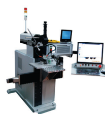
МЛК4-015.150 Волоконный квазинепрерывный QCW 150 Вт, автомат, 4 оси
