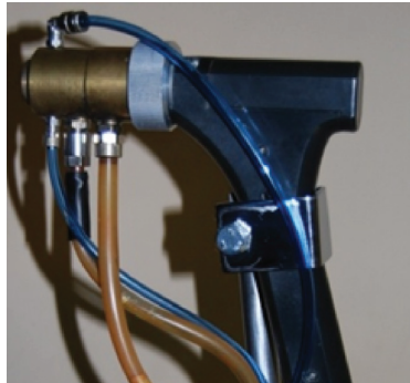
Рис. 2. Общий вид плазмотрона с плазмохимическим реактором.
