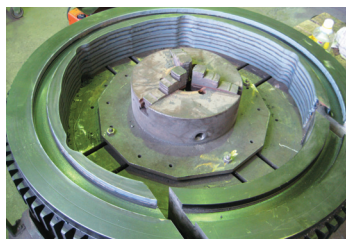
Рис. 2. Шестерня поворотная патрона бурового станка с плазменной закалкой.
