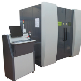
ЛТСК4 Непрерывный волоконный 2-4 кВт автомат, 4 оси, габарит детали 500*700*800-3000 мм
