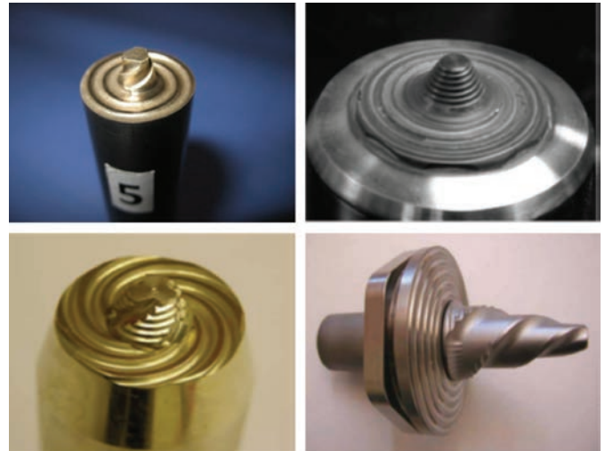
Рис. 4. Рабочие части инструментов для СТП.
