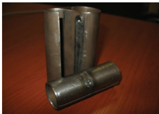
Рис. 11. Образец из конструкционной стали, изогнутый после сварки трением.
