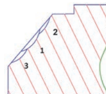
Рис. 9. Порядок закалки образца из стали 20Х13.
