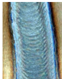
Рис. 2. плазменная дуга (слева) и закаленная полоса с цветами побежалости.
