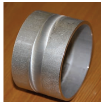
Рис. 15. Элемент трубы, сваренной СТП.
