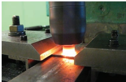
Рис. 10. Перемешивающая сварка трением образцов из конструкционной стали инструментом из кубического нитрида бора.
