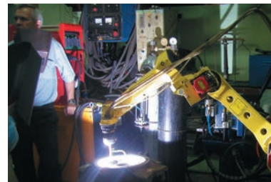
Рис. 3. Закалка установкой УДГЗ-200 с помощью робота.
