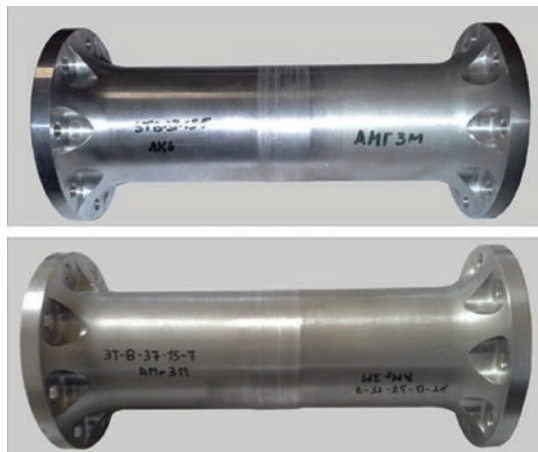
Рис. 13. Трубчатые детали из однородных и разнородных материалов, сваренные СТП.
