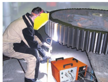
Рис. 1. Закалка установкой УДГЗ-200.
