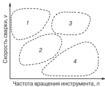
Рис. 2. Зоны режимов СТП: 1 — высокие нагрузки на инструмент, дефекты в виде непроваров из-за недостаточного разогрева; 2 — область оптимальных условий сварки; 3 — сложность поддержания условий сварки, перспективная область режимов сварки, обеспечивающая высокую производительность (высокоскоростная СТП); 4 — перегрев металла и ухудшение его структуры, образование задигов и схватывание с инструментом, заглупление инструмента.
