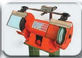
Ограждения заточного оборудования
