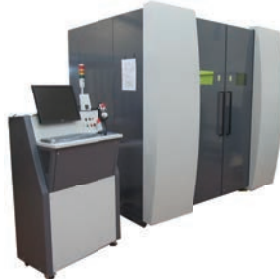
ЛТСК4 Волоконный 2-4 кВт Автомат, 4 оси, габарит детали 500*700*800-3000 мм
