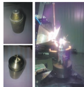
Рис. 10. Процесс лазерного легирования и полученные детали.
