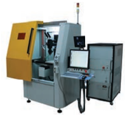
МЛК4-1,2 Nd:YAG 150-250 Вт Автомат, 4 оси
