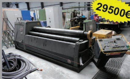
MG MH-2510B – 4-валковые гибочные вальцы Мощность: 2600 x 10 мм – Ø верхнего вала: 220 мм Нижний вал: 210 мм – боковые 170 мм УЦИ – закаленные валы – коническая гибка
