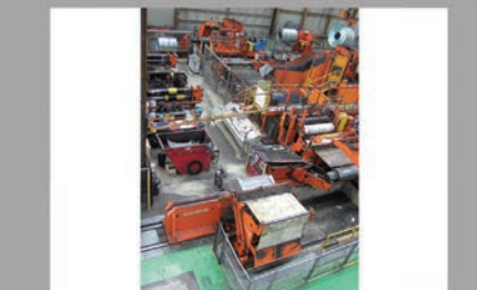
SOENEN – линия продольной резки металла Мощность: 1600 × 5 мм Разматыватель: 27т Правилка – резак – ножницы – наматыватель
