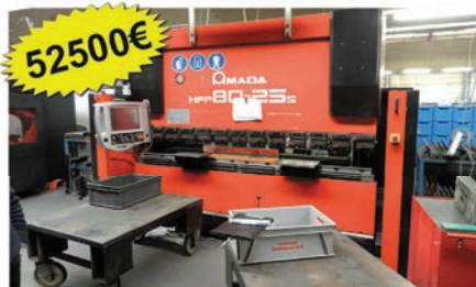
AMADA HFP 80-25S – листогибный пресс Мощность: 80т × 2500 мм – Управление AMBC Управляемые оси: X – R – Z1 – Z2 – Y1 – Y2 Высокоскоростная версия – 20 мм/сек
