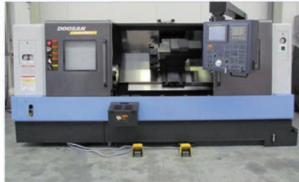
DOOSAN PUMA 300 LMB – токарный станок с ЧПУ Ø точения: 590 мм – отверстие шпинделя: 86 мм Мощность на шпинделе: 22 кВт – ЧПУ: Fanuc 21iTB
