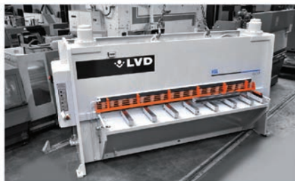
LVD HSL – гидравлические ножницы Ширина листа: 3100 мм – толщина 16 мм Кол-во резов в минуту: 6-25 – Угол: 0°-3.5° Задний упор: 1000 мм – вес 10 тонн
