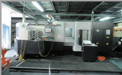
MAZAK FPH-4800 – обрабатывающий центр Размеры столов: 400 x 400 мм – 6 штук X: 560 – Y: 630 – Z: 600 мм Мощность на шпинделе 20 кВт
