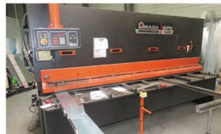
AMADA GPN – гидравлические ножницы с ЧПУ Ширина листа: 3100 мм – толщина 10 мм Направляющая линейка Гидравлическая система поддержки листа
