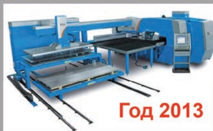
PRIMA POWER SHEAR GENIUS E6 Усилие пробивки: 300 kN Размеры листа: 3074 × 1565 мм Кол-во инструмента: 384 – скорость: 150 м/мин
