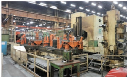
SCHARMANN HEAVYCUT 1.3 – расточный станок Поворотный стол: 1650 x 3500 мм – Нагрузка: 75 т Шпиндель: 160 мм – мощность 37 кВт X: 5500 – Y: 2000 – W: 600 мм – ЧПУ Siemens
