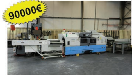
MAZAK MULTIPLEX 630 – токарный станок с ЧПУ Ø точения: 560 мм – отверстие шпинделя: 77 мм ЧПУ – Mazatrol Fussion 640T + барфидер
