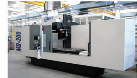
Favretto MD 200 – плоскошлифовальный станок Стол: 2000 x 700 мм, X: 2000 – Y: 900 – Z: 750 мм Ø шлифовального камня: 457 мм – мощность 22 кВт Управление: Siemens Sinumerik
