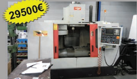
YANG EAGLE 1000 – обрабатывающий центр Стол: 1070 x 500 мм – скорость: 7500 об/мин X: 1000 – Y: 500 – Z: 500 мм Управление: Fanuc O-MD
