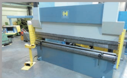
HACO ERM – листогибный пресс с ЧПУ Мощность: 135т × 3100 мм – Управление BC40 Управляемые оси: Y1 – Y2 – X – X1
