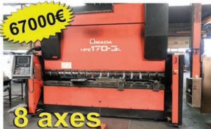
AMADA HFE 170-3 L – листогибный пресс Мощность: 170т × 3000 мм – Управление OP 2000 Управляемые оси: X1 – X2 – R1 – R1 – Z1 – Z2 – Y1 – Y2 Увеличенная высота (стол-ползун) – 620 мм
