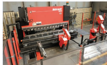
AMADA ASTRO 100 T – роботизированный комплекс Мощность: 100т × 3220 мм – ЧПУ: Astra CAM II Листогиб – 9 осей – Гибочный работ – 5 осей Робот погрузчик – 6 осей
