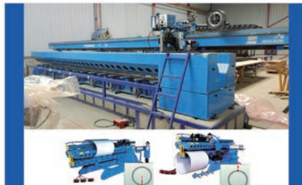
SAF SEAM-MATIC IT 72 – сварочная установка Макс.длина: 7250 мм – внутренний шов: Ø 1600 мм Толщина: 1 – 10 мм – Источник: Nertamatic 450 DC
