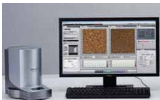
Рис. 17 АСМ MFP-3D-SA (Asylum Research Inc.). АСМ изображение поверхности магнетита, размер скана 1,75x1,75 мкм [3]
