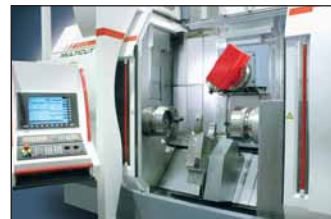
Общий вид рабочей зоны с пультом ЧПУ токарно-фрезерного центра Multicut 500
