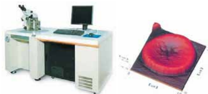
Рис. 15 СЗМ JSPM-5400 (JEOL Ltd.). АСМ изображение эритроцита крови, размер скана 10x10 нм [1]
