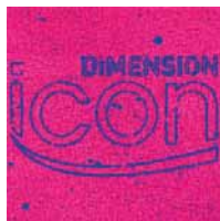
Рис. 16 СЗМ Dimension Icon (Bruker AXS). Логотип, нанесенный методом нанолитографии на поверхность пьезоэлектрика, размер скана 20 мкм. [2]
