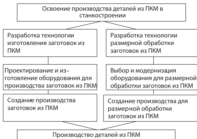
Рис. 1 Структурная схема работ в области применения перспективных конструкционных материалов (ПКМ) для деталей суперпрецизионных и сверхскоростных станков
