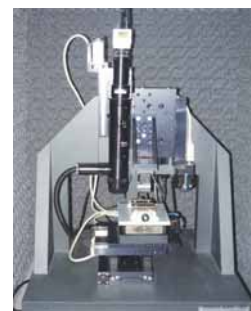
Рис. 18 СЗМ НАНОСКАН 3D (ФГУ ТИСНУМ). Поверхность с нанесенными царапинами, размер скана 5x5 мкм [6]
