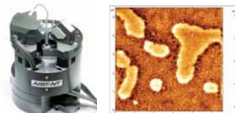
Рис. 21 СЗМ SmartSPM (AIST-NT). АСМ изображение поверхности пленки полистирола, размер скана 5x5 мкм [8]
