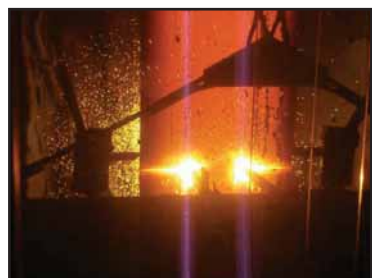
Рис. 1 Машина газовой резки слябов вертикальной УНРС
