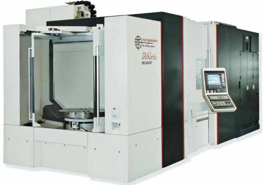
Умная комбинация: мощный высокоскоростной поворотный стол, управляемый от ЧПУ, в сочетании с креплением для токарного инструмента позволяет осуществлять на токарно-фрезерном центре HEC 800 Athletic MT токарную обработку ротационно-симметричных деталей диаметром до 1400 мм
