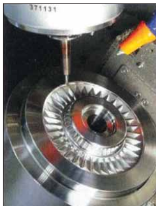
Рис. 5 Пуансон ковочного штампа для горячей штамповки зубчатого колеса диаметром 180 мм
