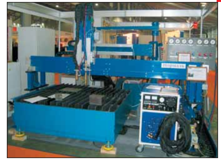
Трехкоординатная порталная машина термической резки листового металла проката с ЧПУ «Нормаль 2.0x6.0-ЗКР» ООО «ПЛАЗМАМАШ». Многоступенчатая система подачи газов.
