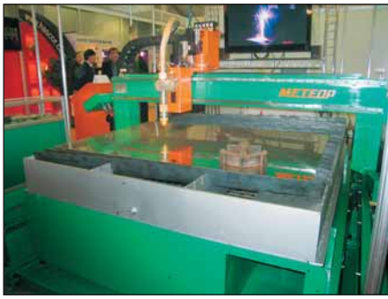
Машина термической резки серии «Метеор» на стенде ООО «Автогенмаш». Поставляется с различной микроплазменной и технологической оснасткой.
