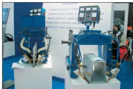
Сварочный трактор фирмы «ШТОРМ» для автоматической одноили двухдуговой сварки сталей. Может использоваться для сварки под флюсом или в среде защитного газа (MIG/MAG), для сварки стыковых, угловых или нахлесточных соединений, с разделкой и без разделки кромок, внутри и вне колеи трактора.
