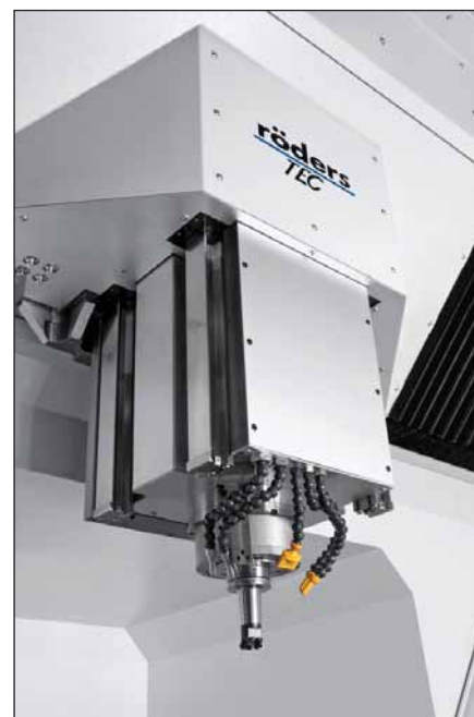
Рис. 2 Головка станка мод. RXU120DSH с направляющими типа QUADROGUIDE
