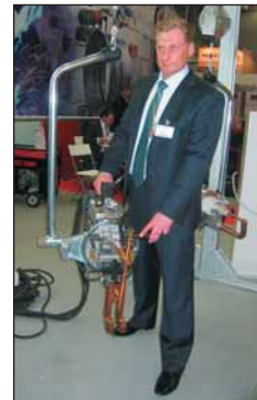
Подвесные клещи контактной точечной сварки для работы в условиях промышленного производства со встроенным блоком управления сварочными параметрами фирмы TESNA на стенде компании «Рутектор».
