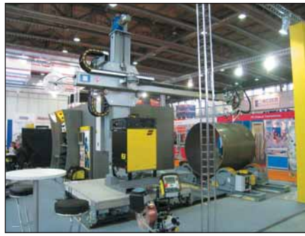
Сварочный центр SaV 300 фирмы ESAB (Швеция) для автоматической сварки. Стандартная установка типа колонна (3-5 м) – консоль (3-5 м). Вращение центра вокруг своей оси на 180° значительно увеличивает зону охвата. Размер 4x4 м позволяет навешивать на торец консоли сварочное оборудование и аксессуары весом до 150 кг.
