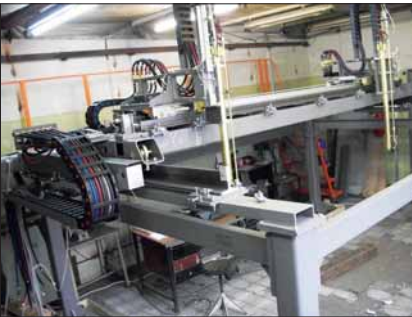
Рис. 3 МГР для порезки слябов толщиной от 250 до 400 мм на мерные заготовки для стана 5000 ЛПЦ ОАО «Выксунский металлургический завод»
