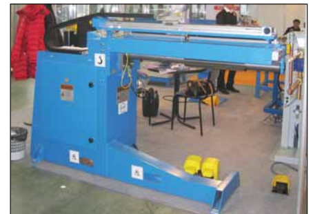
Новинка! Станок шовной TIG сварки Elena 1100 фирмы ООО «СПЕЦТРЕШЕНИЕ». Производит продольную сварку встык труб из нержавеющей стали, а также из низколегированных, высоколегированных сталей, алюминиевых сплавов и цветных металлов.
