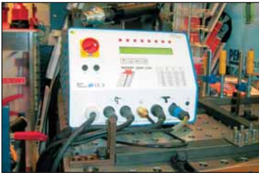
Блок питания ВМК-12 W и пистолет РК-3 фирмы SOYER (Германия) для приварки шпилек электрической дугой (SC и ARC режимы) на стенде ООО «Си Эл Инжиниринг и Ко».
