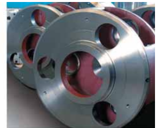
Умная комбинация: мощный высокоскоростной поворотный стол, управляемый от ЧПУ, в сочетании с креплением для токарного инструмента позволяет осуществлять на токарно-фрезерном центре HEC 800 Athletic MT токарную обработку ротационно-симметричных деталей диаметром до 1400 мм
