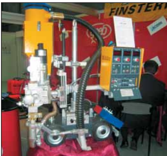
Мобильный самоходный сварочный трактор КА 1-UP фирмы Kjellberg на стенде ООО «НПП «ФЕВ». Осуществляет однодуговую сварку под флюсом проволокой. Предлагается в трех исполнениях: для макс. диаметра проволоки 3 и 5 мм, а также в управляемом варианте. Последнее сконструировано для сварки стыковых и угловых швов конических деталей. Возможно сваривать изнутри труб диаметром 1500 мм и более.
