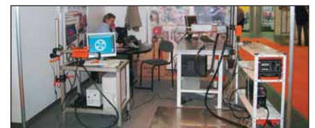
На стенде ЗАО «Дидактические системы» дуговой тренажер сварщика (МДТС) . Позволяет не только имитировать процессы MMA, MIG/MAG и TIG, но и обеспечивает широкие возможности оперативного контроля параметров этих процессов на мониторе компьютера.
