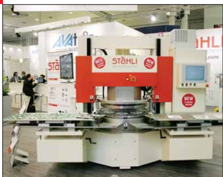
Новая разработка фирмы STANLI Group (Швейцария) – станок серии DLM для суперфинишной обработки.
