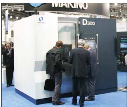
5-ти осевой вертикальный фрезерный обрабатывающий центр D300 производства компании Makino (Япония).
