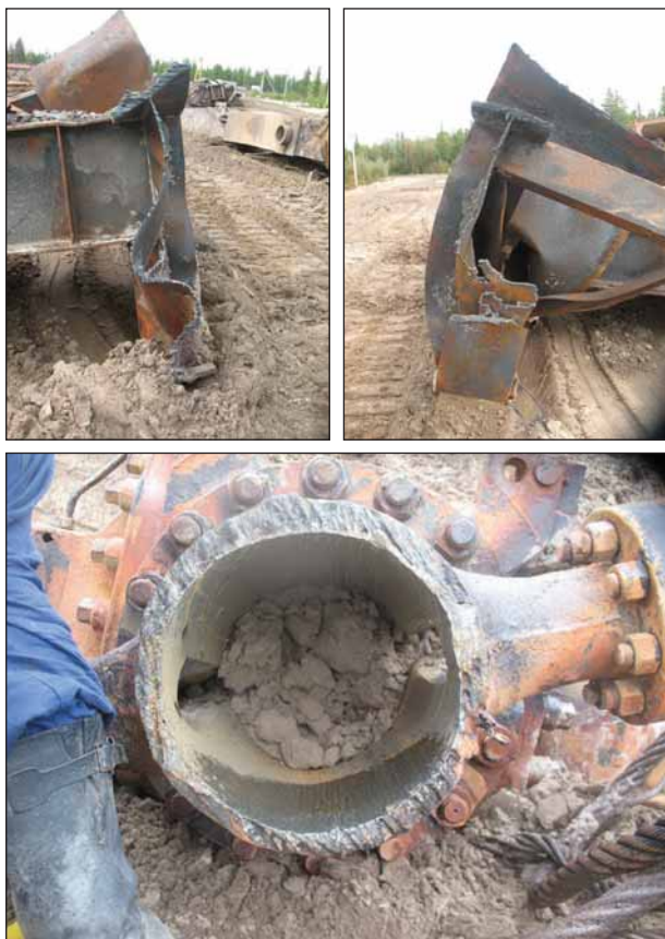
Рис. 5 Результаты лазерной резки несущих конструкций и оборудования буровой установки на скважине № 506 Западно-Таркосалинского НГКМ
