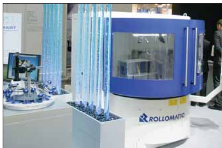
6-осевое устройство правки шлифовального круга ProfileSmart с ЧПУ компании Rollomatic (Швейцария).
