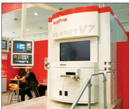
Серия плоскошлифовальных станков Planet V7 с двумя противоположными вертикальными шлифовальными шпинделями для финишной обработки заготовок с диаметром до 180 мм компании Supfina (Германия).
