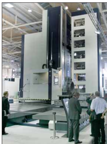
Фрезерный станок с подвижной колонной Soraluce производства группы DANOBAT (Испания).
