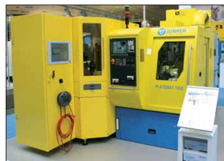
Серия шлифовальных станков Platemat фирмы Junker (Германия) для комплексной обработки поворотных режущих пластин.
