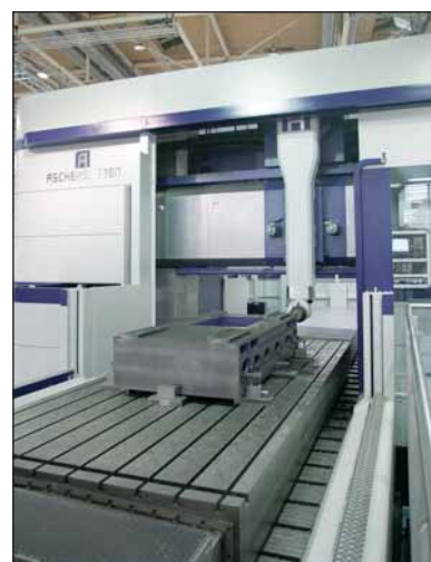
Портальный фрезерный станок ASCHERSLEBEN серии ASCAMILL компании Schiess (Германия).
