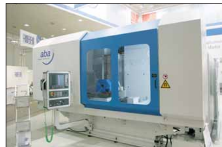
Высокоточный станок для профильного шлифования Starline 800 CNC с системой управления Siemens 840D производства компании aba z&b Schleifmaschinen GmbH (Германия).
