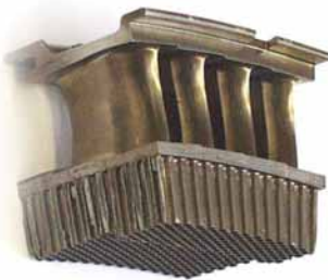
Рис. 12 Блок направляющих лопаток ГТД с сотовым ячеистым уплотнителем, изготовленный методом MIM
