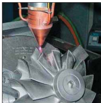
Рис. 6. Процесс нанесения порошкового сплава на законцовки лопаток моноколеса компрессора
