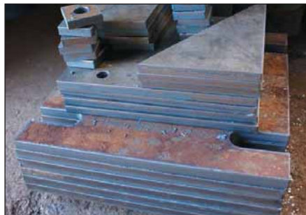
Рис. 1 Закладные детали для металлоконструкции, произведенные на станке плазменной резки, не требуют дополнительной металлообработки
