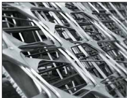
Рис. 2 На высечке хорошо видно высокое качество кромки реза после плазменной резки металла
