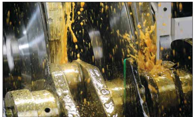
Коленчатый вал двигателя грузового автомобиля в процессе шлифования на станке JUCRANK 6L
