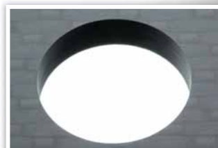
Рис. 4 Деталь: выход из отверстия при диаметре 21 мм (циркулярное фрезерование OptiMill-Composite-Speed)
