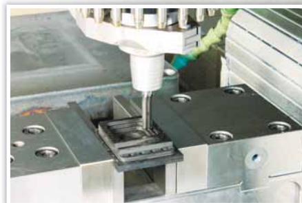
Рис. 1 Черновая и чистовая обработка материала CFK за одну операцию инструментом OptiMill-Composite-Speed
