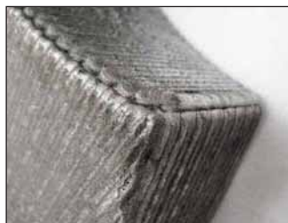
Рис. 7. Вид упрочненной поверхности после лазерной порошковой наплавки
