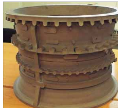
Рис. 9. Заготовка корпуса компрессора ГТД диаметром 700 мм компании Rolls-Royce, полученная методом Net-Shape Powder HIP
