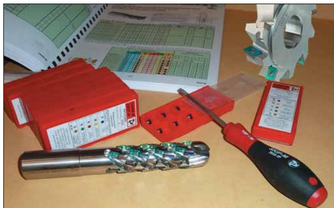
Рис. 3 Фрезы «СКИФ-М» специального исполнения для обработки Ti555.3
