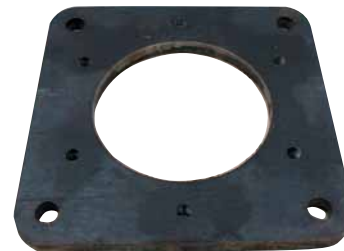
Рис. 4 Фланец квадратный плоский изготовлен на станке плазменной резки. Материал сталь 25, толщина 20 мм, отверстия без резьбы диаметром 22 мм, отверстия с резьбой М12. Высокая точность соосности отверстий +/- 0,1 мм, высокое качество кромки реза, точность размеров +/- 0,25 мм
