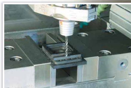
Рис. 2 MEGA-Drill-Composite-UDX предотвращает расслоение и выступание концов волокон на выходе из отверстия
