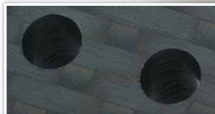
Рис. 3 Деталь: выход из отверстия при диаметре инструмента 4,8 мм (сверление MEGA-Drill-Composite-UDX)
