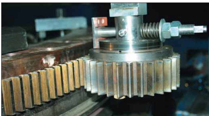
Рис. 4 Прикатывание боковых поверхностей зубьев
