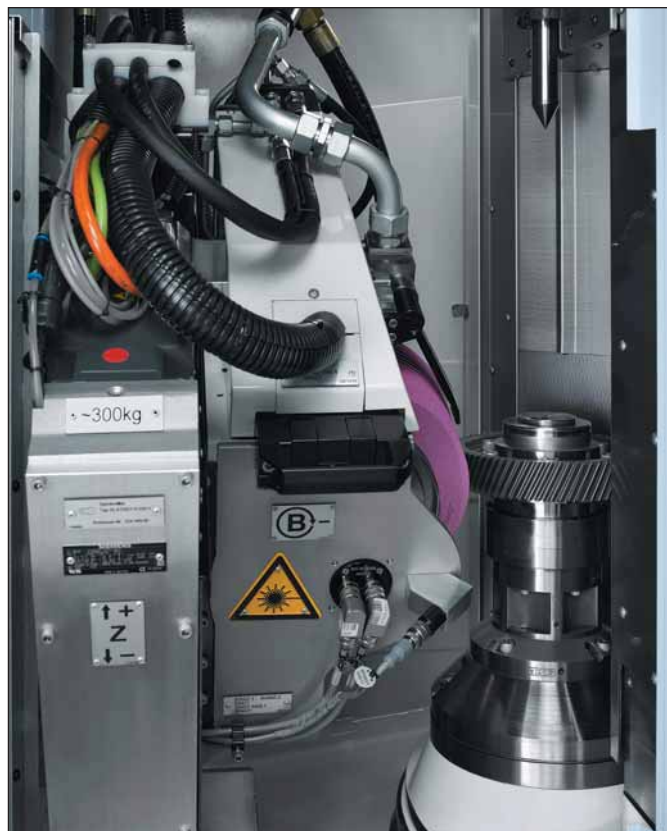
Обратное шлифование зубчатых колес на станке RZ260
