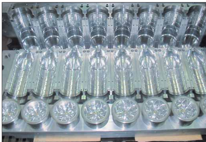
Рис. 1. Результат трехкоординатной обработки матрицы прессформы в ADEM-VX
