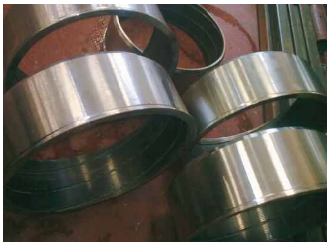
Рис. 5 Детали Петербургского тракторного завода, упрочненные с помощью волоконного лазера ЛС-2
