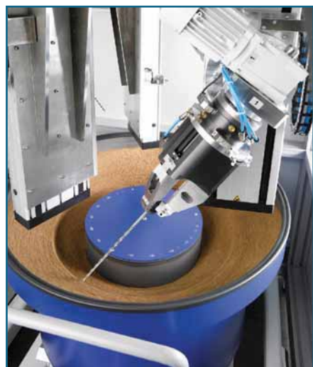
Применение: полировка твердосплавных сверл
