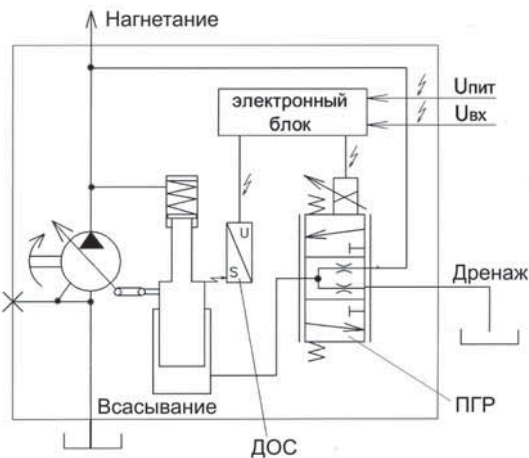
Рис. 3. Схема пропорционального регулирования насоса 313.3.107.056 ОАО «Пневмостроймашина»
