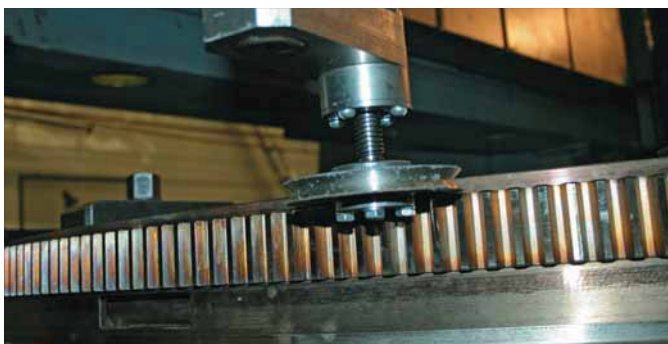
Рис. 5 Удаление заусенцев на торцах зубьев после формообразования фасок
