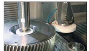
Рис. 6 Встроенное измерительное устройство контроля зубьев
