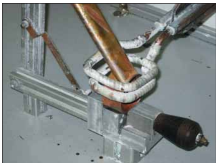
Рис. 3 Индукционная пайка изливов бытовых смесителей с помощью порошка припоя П14 (медь-фосфор-олово)
