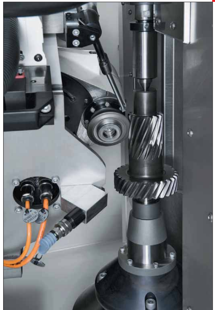
Профильное шлифование зубчатого венца с ограниченным выходом шлифовального круга
