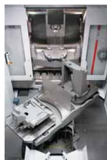
Процесс подготовки сменной заготовки параллельно времени основной обработки для высокопроизводительных 3-, 4-, 5-осевых станков.
