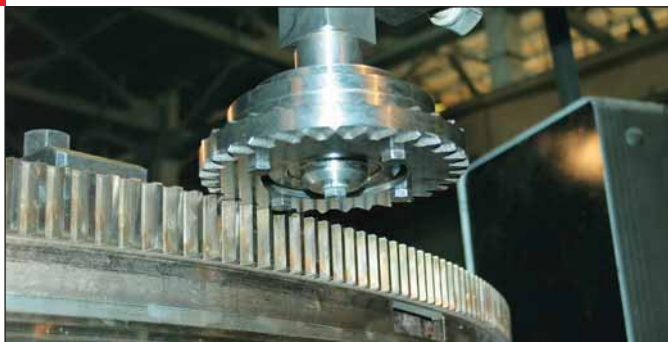
Рис. 3 Формообразование фасок на торцах зубьев
