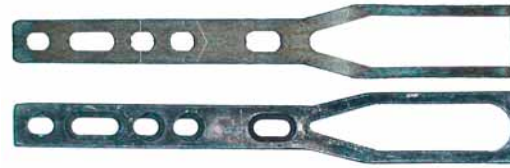
Рис. 8 Заготовка из титанового сплава после лазерной вырезки (сверху) и конечное изделие (внизу)
