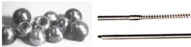
Рис. 7 Фрагменты упрочненных эндопротезов и имплантатов (винт-стержень спонгиозный) с лазерным поверхностным упрочнением
