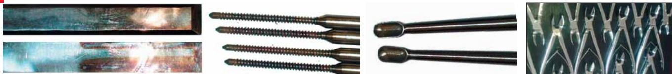
Рис. 6 Образцы медицинского инструмента, термоупрочненные лазером: а) стамески б) метчики в) ложки хирургические г) кусачки медицинские
