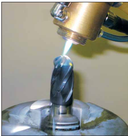
Осаждение покрытия на фрезу
