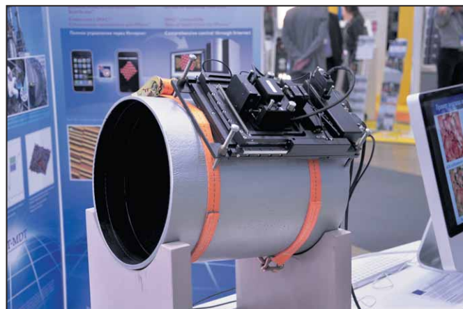
Программно-аппаратный комплекс для промышленной диагностики СОЛВЕР Пайп впервые представлен на выставке RUSNANOTECH 2010.
