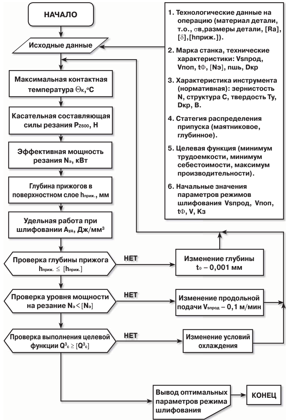
Рис. 2. Алгоритм назначения оптимальных режимов шлифования
