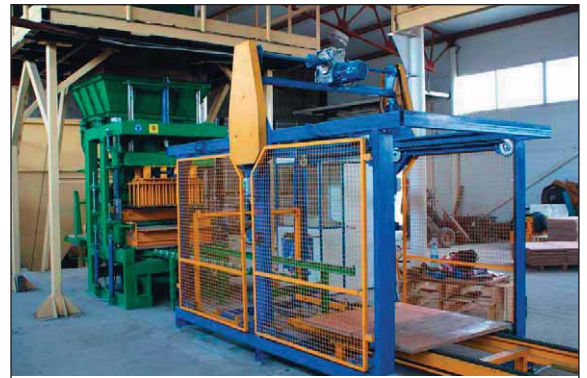
Технологическая линия для производства бордюра НПТЦ «КВАДР»
