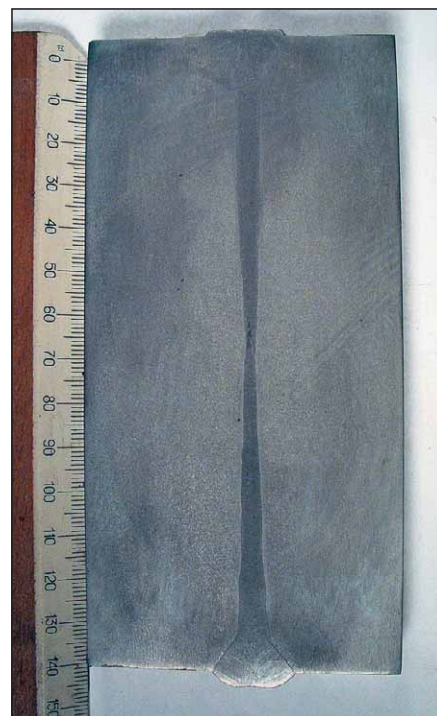
Рис. 4. Макрошлиф сварного соединения аустенитной меди 316 L(N) толщиной 140 мм
