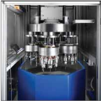
Рис. 1. Драг финишный станок с планетарным приводом и многопозиционными держателями инструментов для качественного и совершенного процесса обработки. Рисунок: OTEC GmbH, ФРГ
