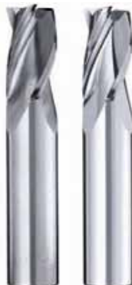
Рис. 5. Твердосплавная торцевая фреза до и после драг финишного процесса. Рисунок: OTEC GmbH, ФРГ
