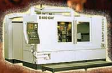
Станок модели S 680 GW для шлифования ходовых винтов и червяков
