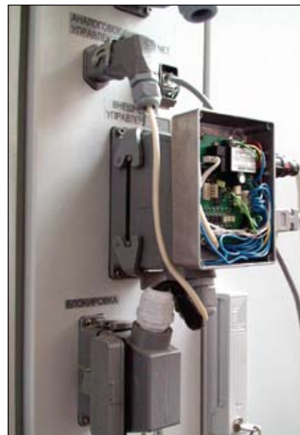
Рис. 3. Внешний вид контроллера MLC01 со снятой крышкой на задней стенке лазера
