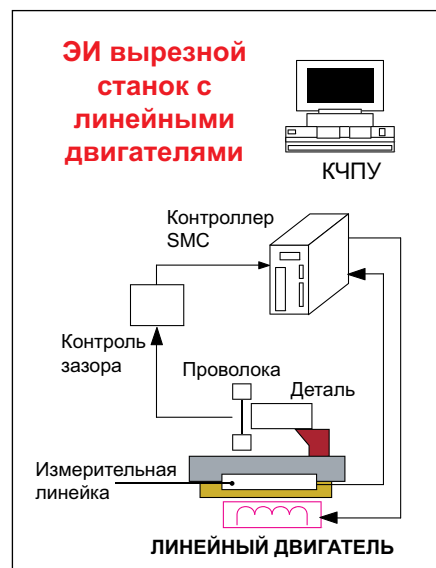
Рис. 3. Схема линейного сервопривода осей X/Y проволочно-вырезных ЭИ станков
