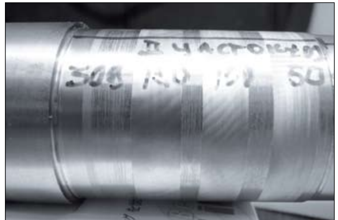
Рис. 1. Участки, обработанные с ультразвуком и без него. (Фото национальной технологической группы)
