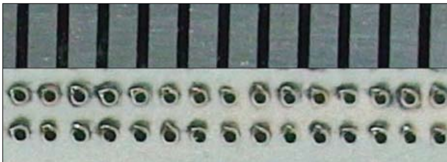
Рис. 5. Характерная форма отверстий, формируемых при импульсной модуляции. Нержавеющая сталь 0,5 мм
