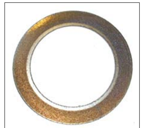
Рис. 7. Пример кольцевого фильтра из нержавеющей стали толщиной 1 мм. Размер отверстий – 140 мкм, плотность – 7,5 отв/мм 2
