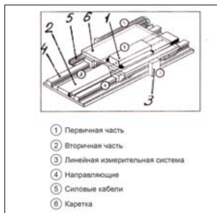
Рис. 4. Схема линейного синхронного серводвигателя фирмы Siemens
