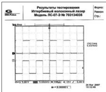
Рис. 1. График модуляции выходной мощности на частоте около 5 кГц из паспорта лазера LC-0.7. Снизу – задающие импульсы, сверху – выходная мощность лазера. Длину фронта нарастания и спада можно оценить как 10 мкс
