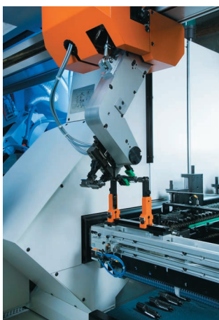
С помощью загрузочного портала с двойным поворотным захватом специалистам компании KOEPPER удалось значительно сократить вспомогательное время.
