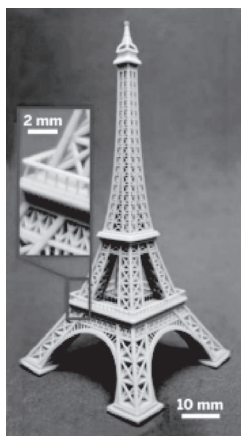
Рис. 5. Разрешение на примере печати модели Эйфелевой башни. Скорость 100 мм/час.
