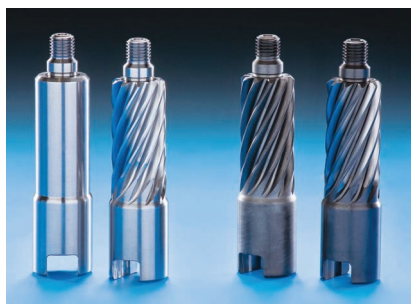
Шестерни — основные детали системы рулевого управления. На картинке изображена заготовка после каждого этапа обработки: точение, (мягкое) предварительное фрезерование с контролем положения зубчатого венца, закаливание и (твердое) чистовое «бреющее» зубофрезерование.
