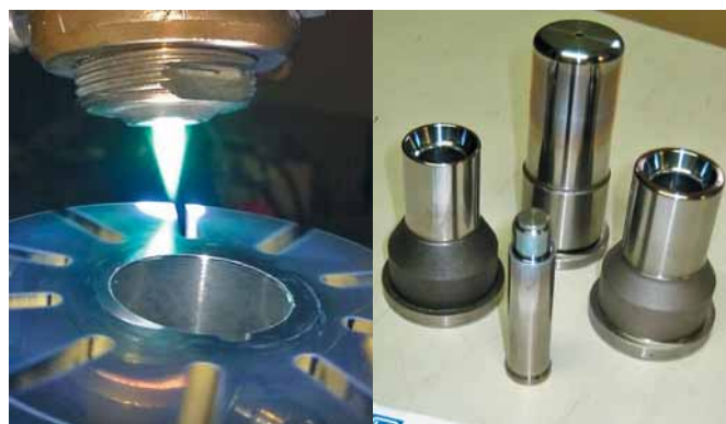
Рис. 5. Финишное плазменное упрочнение деталей гидравлических (а) и топливных агрегатов (б) с покрытием системы Si-O-C-N
