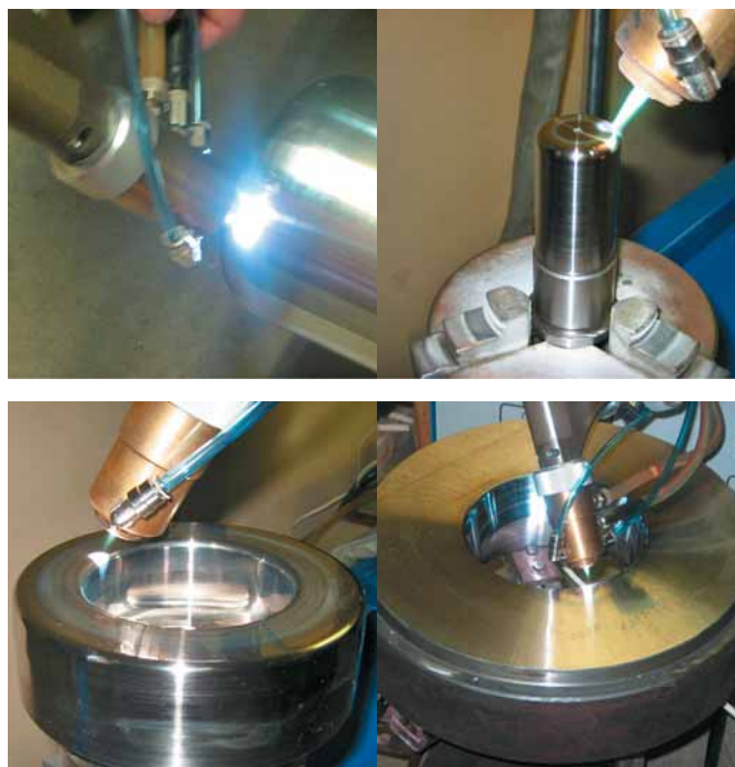
Рис. 3. Процесс финишного плазменного упрочнения матриц и пуансонов вытяжных штампов
