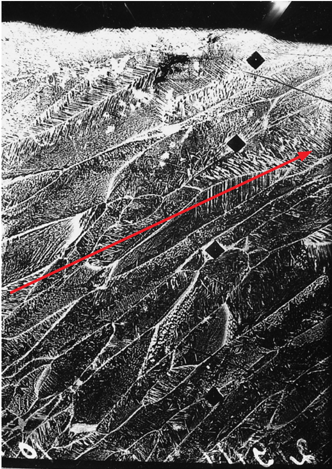
Рис. 6. Направленность структуры после лазерного упрочнения
