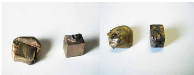
Рис. 5. Оплавленный изолированный и заземленный образцы; температура плавления первого 480 °С, второго 820 °С
