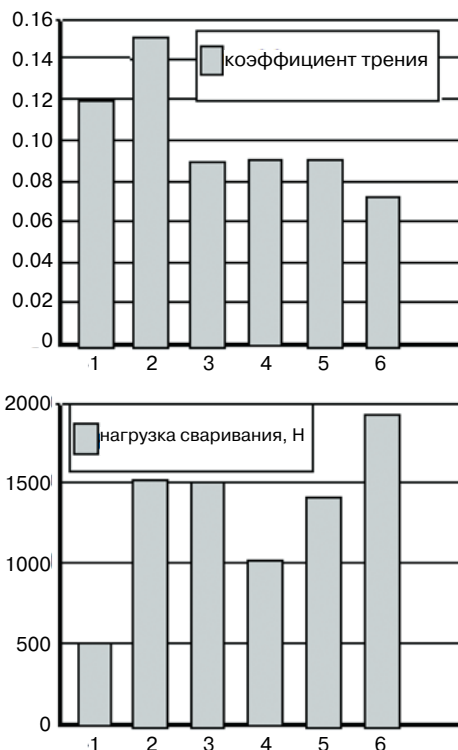
Рис. 2. Результаты испытания фторсодержащих присадок, введенных в масло М-5/10Г2: 1 - моторное масло без фторсодержащей присадки. Далее в масло введены: 2 - присадка LM фирмы Liqui Moly, 3 - присадка WM фирмы WYNN'S, 4 - SLA-1 фирмы Acheson, 5 - SLA-3 фирмы Acheson, 6 - присадка СамГТУ
