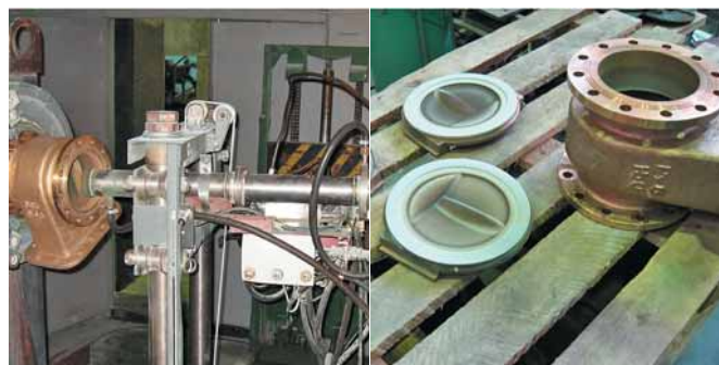
Рис. 2. Процесс детонационного напыления трибологических покрытий трубопроводной арматуры
