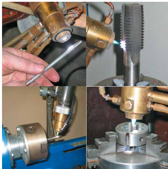
Рис. 1. Процесс детонационного напыления трибологических покрытий трубопроводной арматуры
