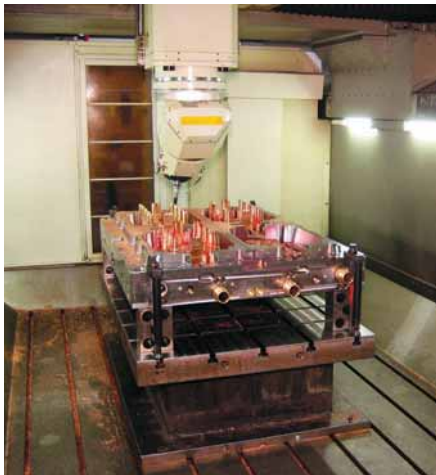
Рис. 1. Все изготовленные в Triangle Tool штампы и пресс-формы были созданы на станках с ЧПУ при помощи разработанных в САМ-системе PowerMILL управляющих программ
