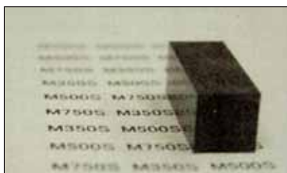
Рис. 8. Фото детали, обработанной на станке мод M 500S, с Ra=0,05 мкм
