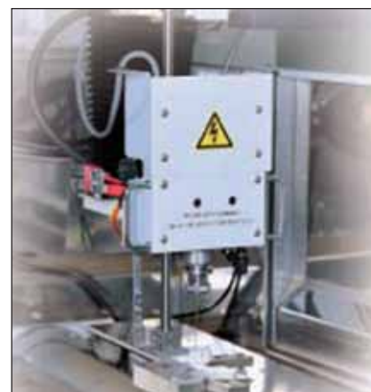
Рис. 9. Устройство для скоростной прошивки отверстий периферийного оборудования и ПО для создания гибких производственных систем.
