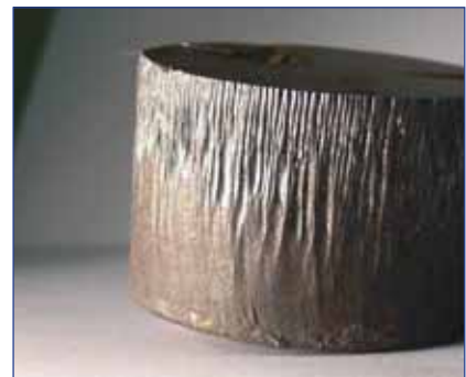
Рис. 2. Поверхность реза низкоуглеродистой стали толщиной 20 мм. Мощность волоконного лазера 2,5 кВт, скорость резки с кислородом 600 мм/мин
