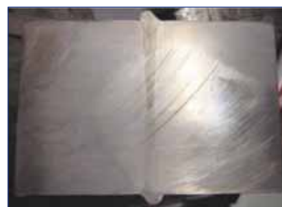
Рис. 5 Сварка стали толщиной 50,8 мм (двухсторонняя). Мощность волоконного лазера 20 кВт, скорость сварки 600 мм/мин (выполнено IPG Laser GmbH)
