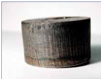
Рис. 1. Поверхность реза низкоуглеродистой стали толщиной 16 мм. Мощность волоконного лазера 2 кВт, скорость резки с кислородом 550 мм/мин
