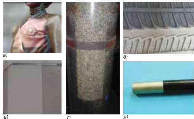
Рис. 5. Фотографии различных изделий, подвергнутых лазерной очистке: А) бронзовая статуэтка Б) очистка пресс-формы В) лабораторная кювета Г) полоса очистки на мраморном изделии Д) очистка металлической детали от краски
