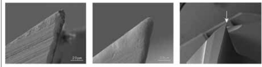
Рис. 4 Твердосплавная торцевая фреза со скосом (слева) и закругленная (посередине). Рисунок: OTEC GmbH, ФРГ
