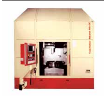
Рисунок 4. Вертикальный станок Mikrotorn CNC — высокая точность, порталный блок из натурального гранита
