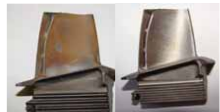
Рис. 7. Турбинные лопатки, очищенные лазерным излучением
