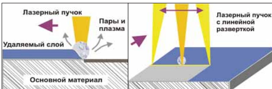
Рис. 1. а) схема процесса лазерной очистки б) схема со сканированием лазерного пучка
