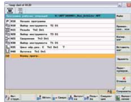
Рис. 7 Пример программы с последовательным выполнением технологических переходов
