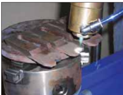
Рис. 4. ФПУ отрезных ножей для штамповки шариков Ø5,953 на холодновысадочных автоматах (ЗАО «Вологодский подшипниковый завод», Вологда). Повышение стойкости в 5 раз
