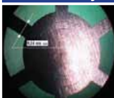
Фрагмент сферической сетки из молибдена (МЧ) толщиной 0,07 мм
