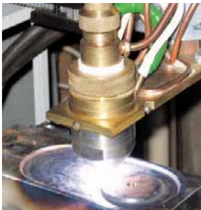
Рис. 2. Плазменная наплавка – напыление задвижки газовой арматуры
