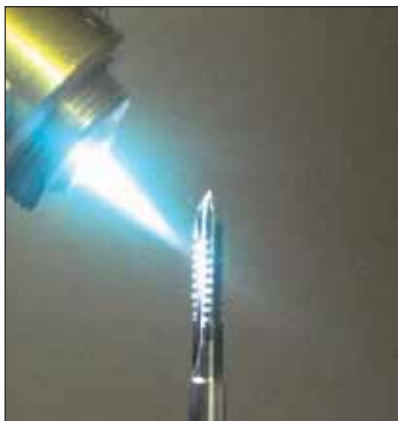
Рис. 3. ФПУ метчика М5х0,8 (ОАО ПО «Стрела», Оренбург). Повышение стойкости в 8 раз
