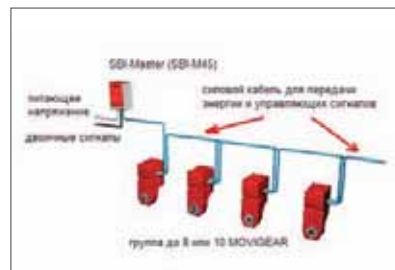
Рис.2 Передача энергии и управляющих сигналов по силовому кабелю
