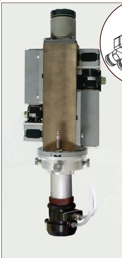
Рис. 4. Вариосистема VF001W с сопловой сварочной насадкой
