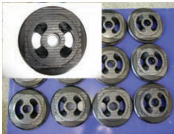
Рис. 4. Внешний вид деталей после закалки
