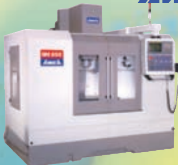
Мощные вертикальные обрабатывающие центры для тяжелого фрезерования серии VM фирмы AWEA
