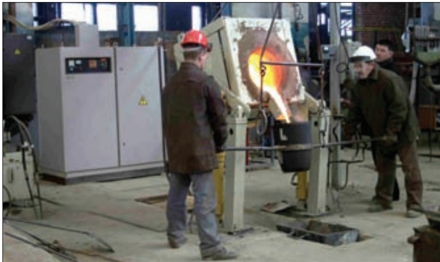
Рис. Индукционная плавильная установка ИСТ-0,4/0,32
