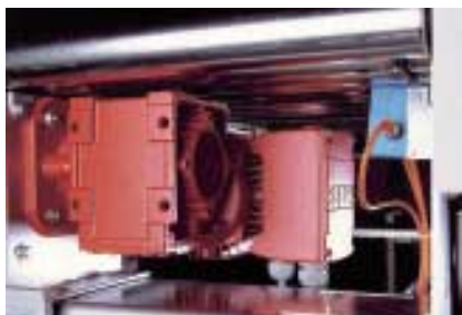
рис.10 Спироидный мотор-редуктор типа W... для роликового конвейера
