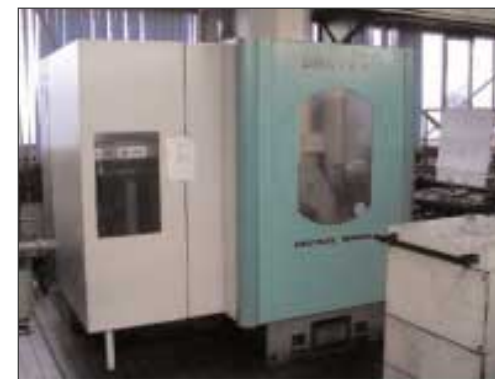
▲ Обрабатывающий центр Decker DMC70V. X-700 мм, Y-550 мм, Z-500 мм. Размеры стола: 900x550, 10-15000 об/мин. 1997 год выпуска. Состояние отличное. 30 инструментов.
