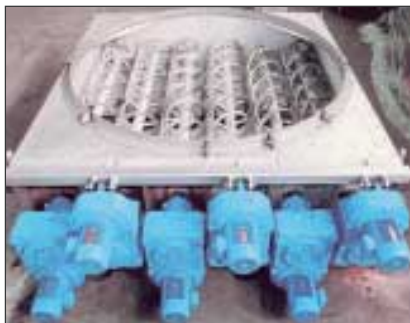
Рис.4. Миксер в химической индустрии с плоскими цилиндрическими редукторами
