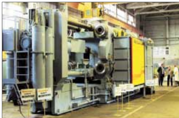
Машина для литья под давлением с усилием запирания 3500 тонн, после модернизации с заменой узла прессования.
