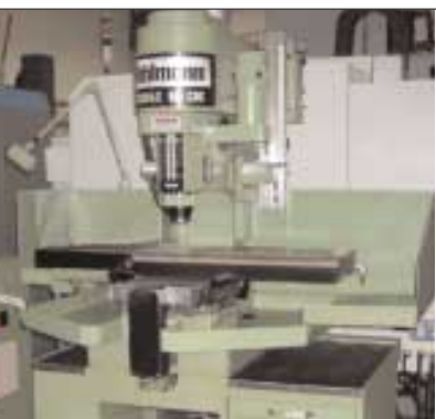
▲ Универсальный фрезерно-сверлильный PicoMax51CNC. X-420 мм, Y-240 мм, Z-420 мм. Стол 730x280 мм. 1988 год выпуска.
