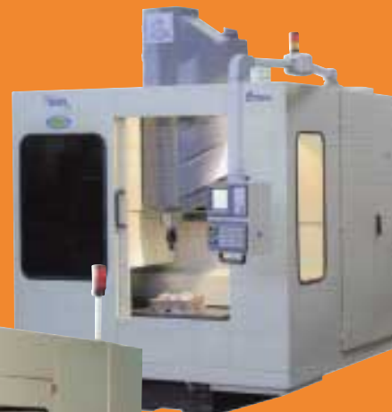
Вертикальный сверлильно-фрезерно-расточной станок с ЧПУ, высокой точности модели 400V
