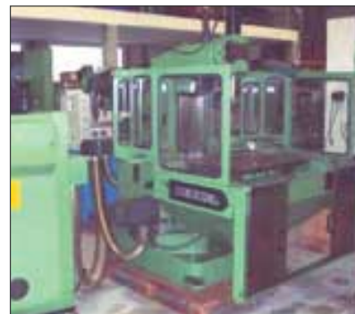
▲ Фрезерный станок Decker FP3NC. Стол 800x290 мм. 1985 год выпуска.
