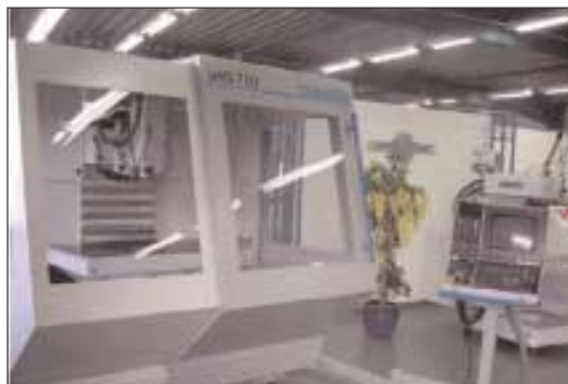
▲ Высокоскоростной универсальный фрезерный станок Mikron UMS 710 HS (Швейцария). Перемещение по осям: X-710 мм, Y- 630 мм, Z-500мм. 100-42000 об/мин, 1996 год выпуска, Состояние отличное. Гарантия 6 месяцев.
