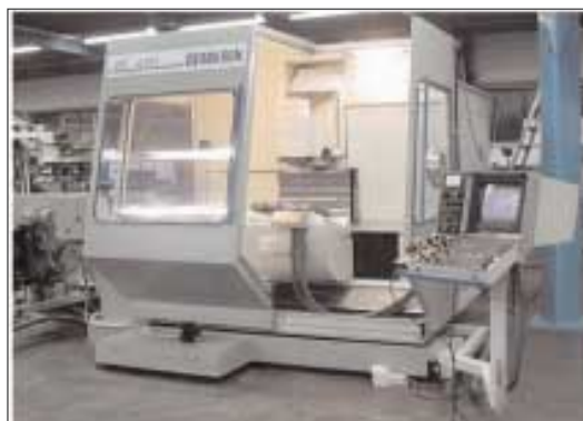
▲ 5-осевой горизонтально-вертикальный обрабатывающий центр MIKRON WF54VH. 1996 год выпуска. X-710 мм, Y-630 мм, Z-500 мм. 10-6300 об/мин. Гарантия 6 месяцев. Состояние отличное
