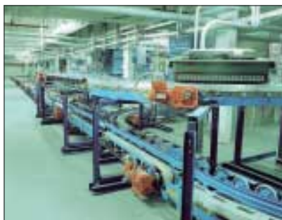
Рис.6. Цилиндро-конические мотор-редукторы К... для транспортировки грузов в аэропорту
