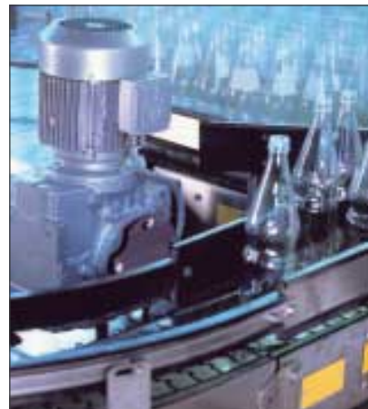
Рис.8. Использование цилиндро-червячных мотор-редукторов S... в линии по розливу
