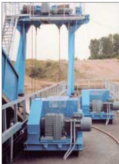
Рис.2. Соосно-цилиндрический мотор-редукторы R в эксплуатации на земснаряде
