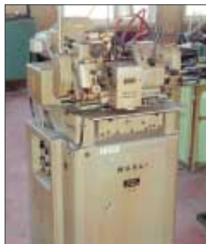
▲ Прецизионный зубофрезерный WANLI W90. Диаметр 40, L- 50мм, РМЦ- 80 мм, 1983 год выпуска. Состояние отличное.
