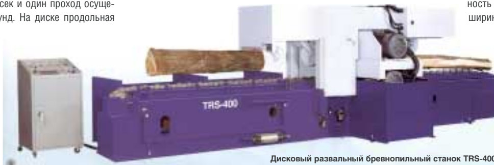
Дисковый развальный бревнопильный станок TRS-400.
