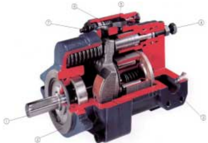
Рис. 2. Регулируемый аксиально-поршневой насос фирмы Bosch: 1 - приводной вал, 2 - монтажный фланец, 3 - отверстие всасывания, 4 - винт ограничения подачи, 5 - отверстие для прокачки через корпус, 6 - регулятор давления, 7 - винт настройки давления.
