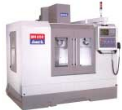
Мощный вертикальный обрабатывающий центр BM 850 для тяжелого фрезерования, фирма AWEA
