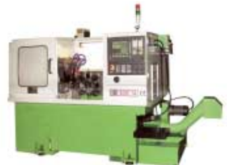
Токарный автомат серии LNT, фирма LICO
