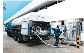
Рис. 3. Поставка газа в жидкой фазе. Наполнение ёмкостей при помощи крионасоса
