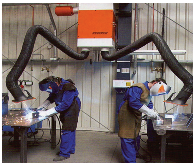
Рис. 9. Оборудование рабочего места сварщика
