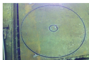
Рис. 7. Деталь, вырезанная методом постепенного формирования точки прожига
