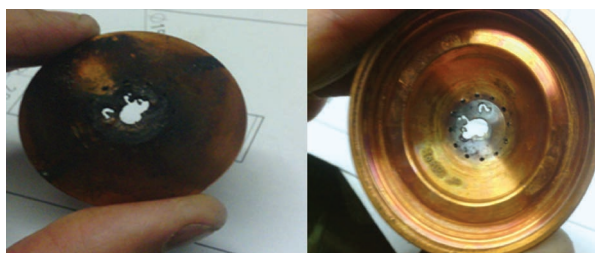
Рис. 4. Повреждения защитного колпачка после удаления застывшего шлака
