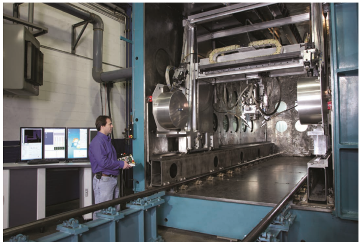
Рис. 4. Электронно-лучевая установка в аддитивном производстве
