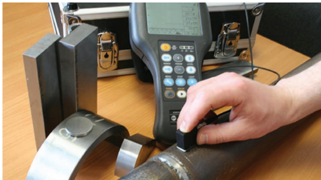
Рис. 8. Проверка качества сварного шва и металла трубы ультразвуковым дефектоскопом A1212 Мастер
