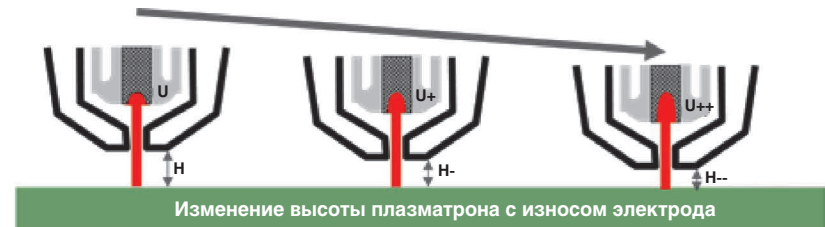
Рис. 3. Изменение высоты плазматрона от износа электрода
