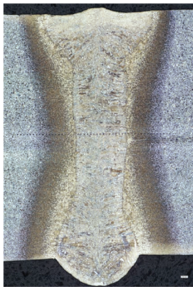
Рис. 11. Пример сварного соединения, выполненного лазерной сваркой по вставке волоконным лазером: марка сталь 40, толщина 8 мм, скорость сварки 1 м/мин, мощность лазерного излучения 9,5 кВт [5]
