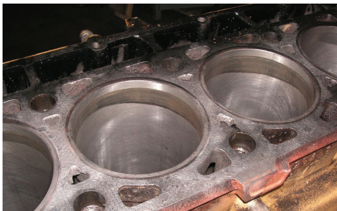
Рис. 3. Изношенные гильзы цилиндров двигателя CAT-3116
