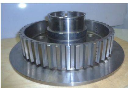
Рис. 3в. Деталь «барабан» фрикционного механизма до лазерной обработки
