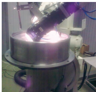
Рис. 11. Процесс лазерного упрочнения втулок горизонтального шарнира
