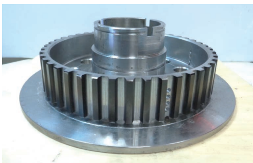
Рис. 8. Деталь «барабан» после нанесения поглощающего покрытия
