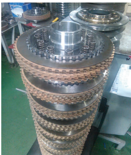
Рис. 3б. Барабаны в сборе с фрикционными дисками
