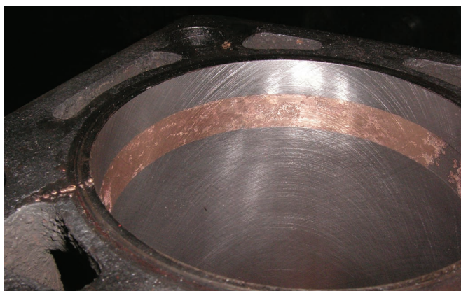
Рис. 5. Восстановленные гильзы цилиндров двигателя CAT-3116 (после механической обработки)
