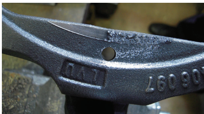
Рис. 7. Восстановленный участок чугунной вилки переключения передач КПП
