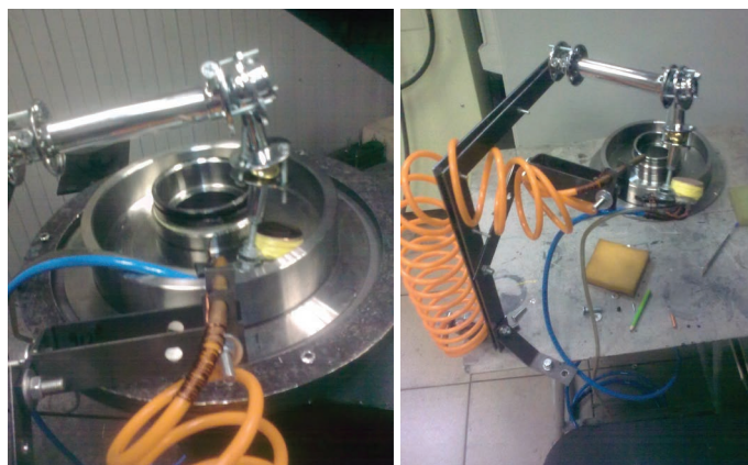
Рис. 14. Изготовленные оправки для крепления зеркала и подвода охлаждающей воды для упрочнения труднодоступной канавки
