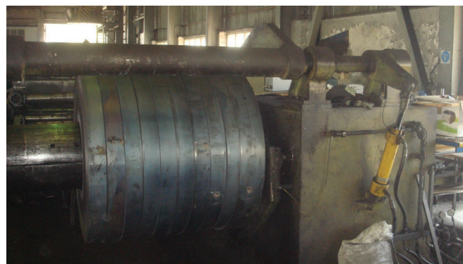
Рис. 8. Общий вид станка наматывания штрипса продольной резки
