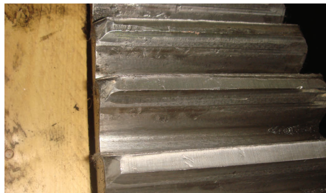
Рис. 9. Изношенные зубья колеса
