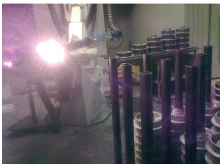
Рис. 10. Промышленное упрочнение барабанов
