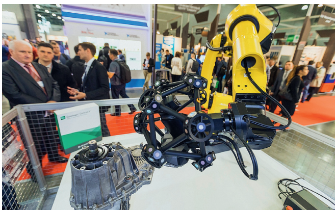
Рис. 2. Автоматизированная система 3D-сканирования Creafom MetraSCAN 3D-R
