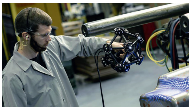
Рис. 1. 3D-сканер метрологического класса Creaform MetraSCAN BLACK — новинка 2020 года
