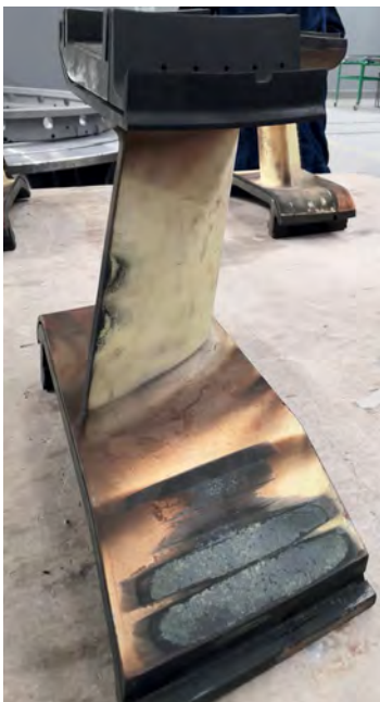
Фото 1. Направляющая лопатка 1-й ступени газовой турбины типа V94.2 до восстановительного ремонта.
