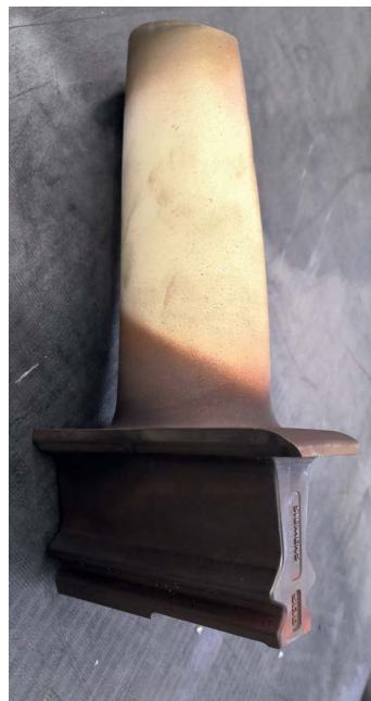
Фото 1. Направляющая лопатка 1-й ступени газовой турбины типа V94.2 до восстановительного ремонта.
