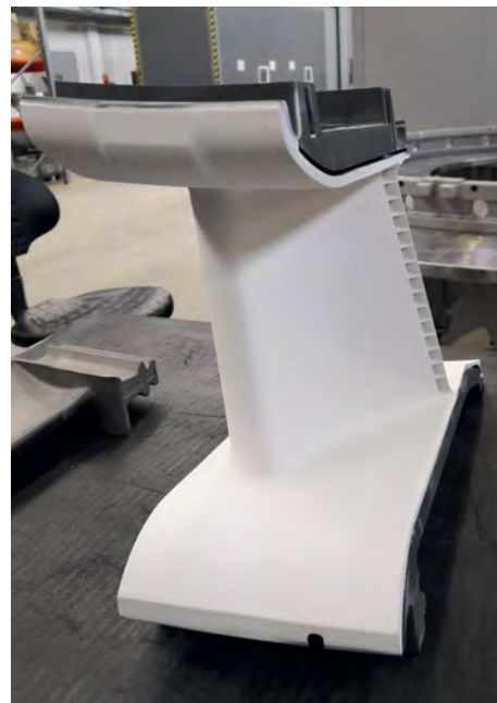
Фото 2. Направляющая лопатка 1-й ступени газовой турбины типа V94.2 после восстановительного ремонта.
