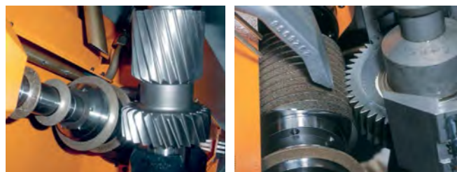
Рис. 12. Станок Liebherr LCS 380, работающий обкатным и профильным методом
