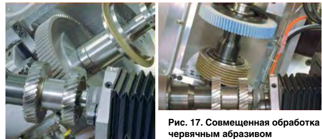
Рис. 16. Профильное шлифование и хонингование на станке S400GT
