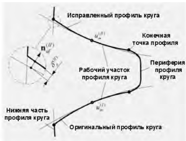
Рис. 7. Нормальная функция коррекции осевого профиля круга [4]
