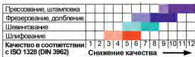
Рис. 4. Параметры точности по ISO 1328, достигаемые различными методами зубообработки [2]
