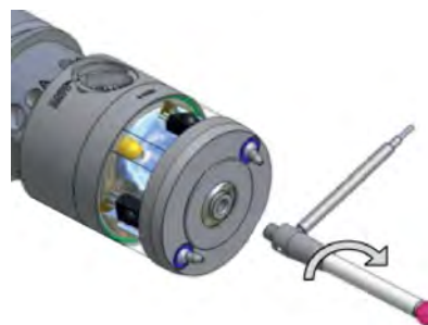
Рис. 7. Пример установки ломкой вставки
