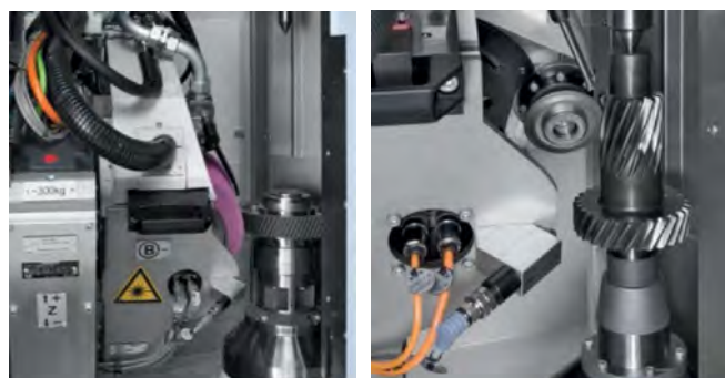
Рис. 11. Станок Reishauer RZ 260, реализующий обкатной и профильный методы.
