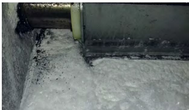
Рис. 4. Пенообразование в процессе резания
