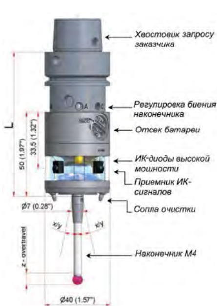
Рис. 6. Конструкция датчика системы измерения и контроля детали
