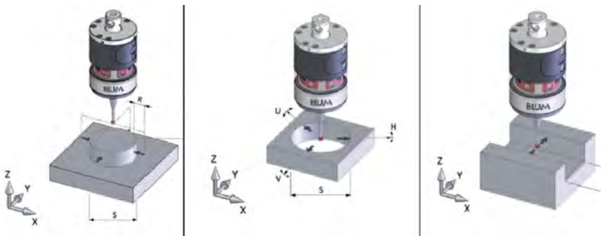
Рис. 12. Примеры стандартных измерительных циклов Blum
