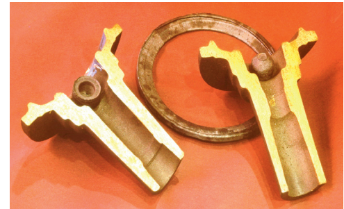
Рис. 5. Общий вид поковки цапфы после штамповки: 1 — отходы после штамповки КВС, 2 — отходы после традиционной штамповки
