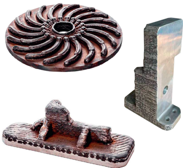
Рис. 2. Примеры заготовок, полученных DED-W-технологией
