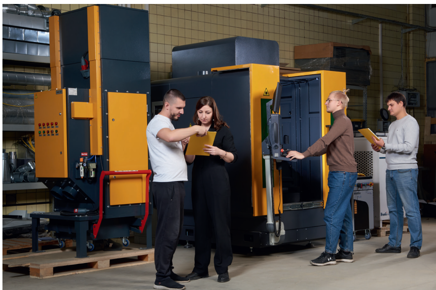
Рис. 2. Станок пятикоординатной обработки СЛП520 для резки, сварки и перфорации отверстий
