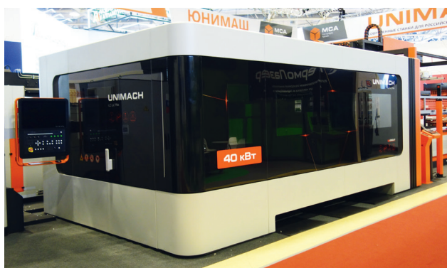
Рис. 5. Лазерный станок Unimach LC Ultra, оснащенный излучателем мощностью 40 кВт компании «Морсвязьавтоматика»
