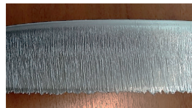
Рис. 2. Образец лазерной резки алюминиевого сплава толщиной 40 мм компанией «ВНИТЭП»
