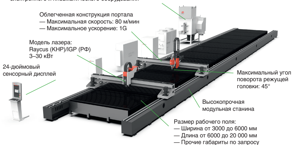
Рис. 7. Широкоформатный 5-осевой станок лазерной 3D-резки WALC для обработки нестандартных листов и резки крупногабаритных деталей компании HGTECH (Китай) от дистрибьютора «ЛЛС»
