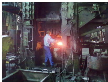
Рис. 1. Штамповка на кривошипном горячештамповочном прессе 25МН: 1 — общий вид пресса; 2 — поковка полуосевой шестерни
