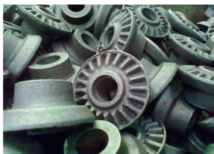
Рис. 1. Штамповка на кривошипном горячештамповочном прессе 25МН: 1 — общий вид пресса; 2 — поковка полуосевой шестерни
