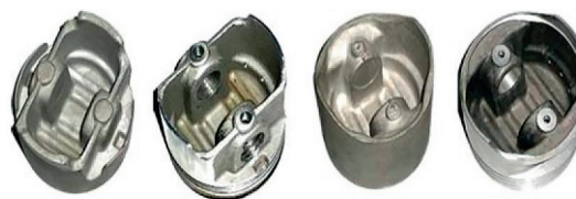
Рис. 2. Алюминиевые поршни после изотермической штамповки на гидравлическом прессе силой 2,5МН: 1 и 3 — изотермическая штамповка; 2 и 4 — механообработка
