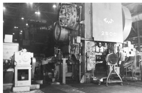
Рис. 3. Автоматизированная линия ТМП на базе горячештамповочного пресса силой 25МН для штамповки полуосевых шестерен
