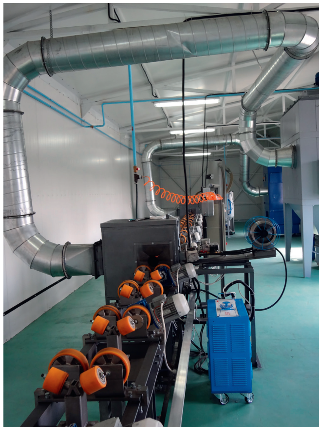
Рис. 1. Автоматизированная линия для нанесения металлизированных покрытий электродуговым методом
