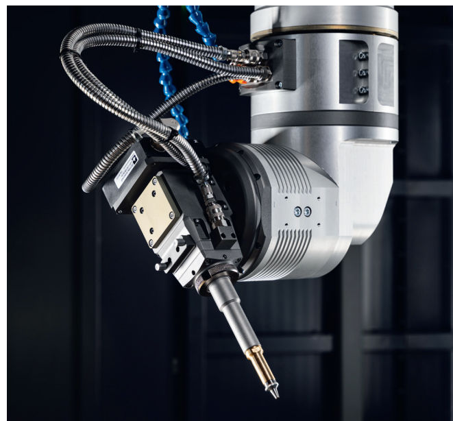
Рис. 2. Сопловая насадка для резки и перфорации станков серий СЛ и СЛП
