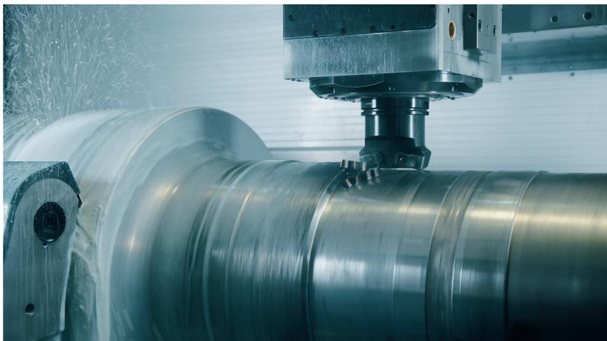
Ось В обрабатывающего центра позволяет корректировать угол наклона под необходимую длину реза во время токарной обработки, тем самым повышая скорость подачи (фото: Weingärtner)
