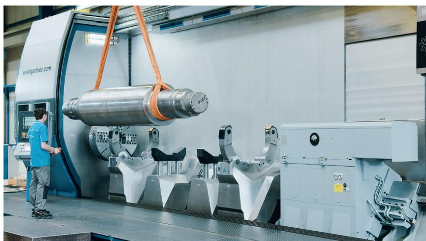
Два устройства загрузки с ЧПУ-управлением предназначены для установки и снятия валков (фото: Weingärtner)
