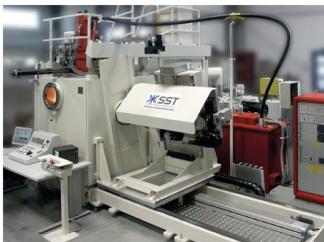
Рис. 4. Установка для перфорирования электронным лучом фирмы Steigerwald с многокоординатным ЧПУ (высокоскоростной электронно-лучевой перфоратор)
