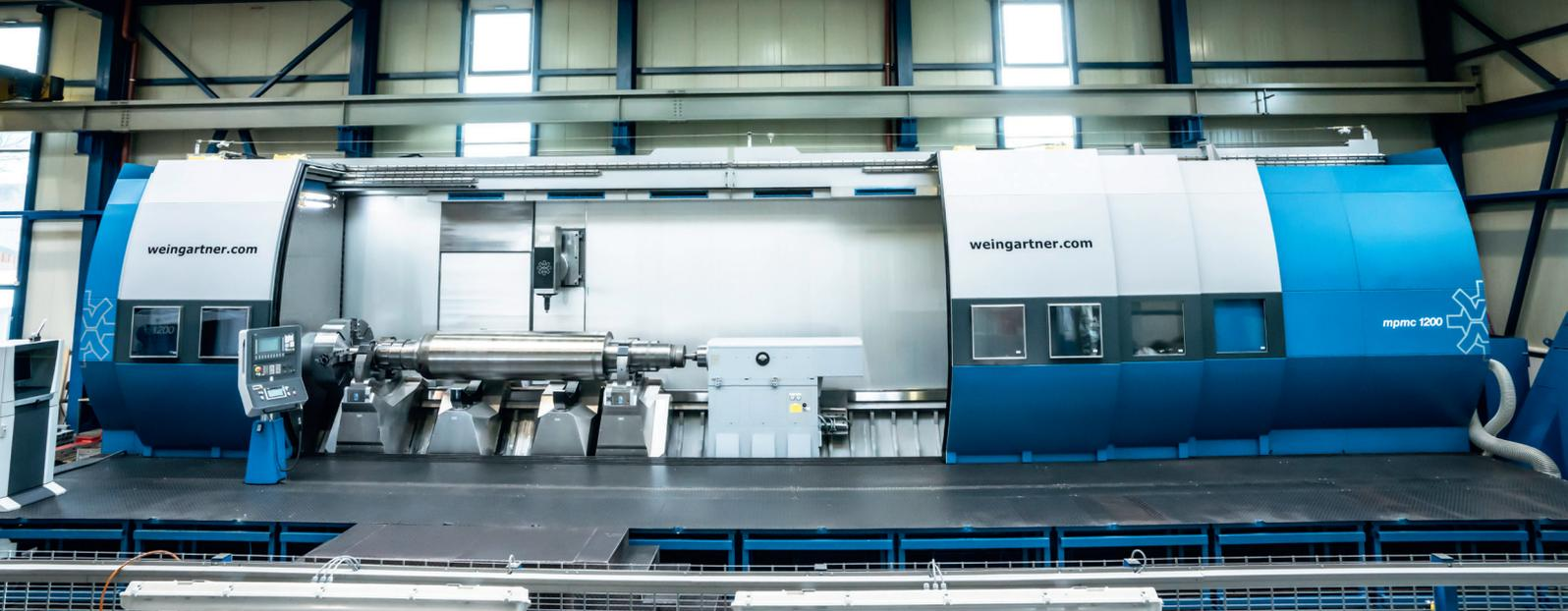
Станок МРМС был спроектирован по спецификации заказчика для полного цикла обработки валков (фото: Weingärtner)
