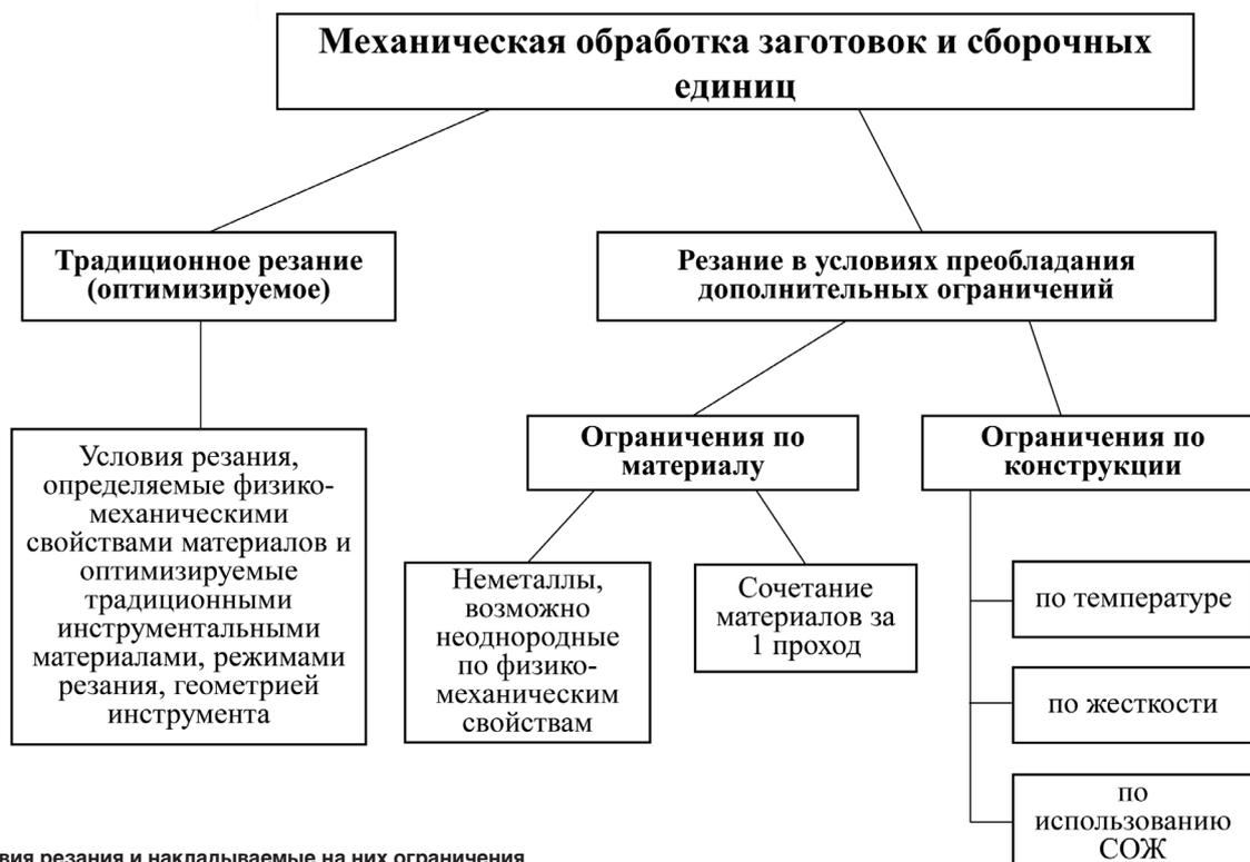
Рис. 1. Условия резания и накладываемые на них ограничения
