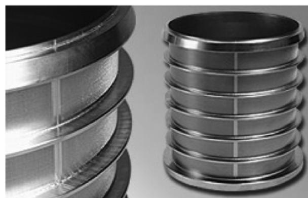
Рис. 5. Фильтр из нержавеющей стали толщиной 1,5 мм с 350000 отверстиями диаметром 0,1 мм, полученными электронно-лучевым сверлением
