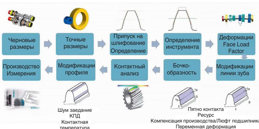
Рис. 4. Общая схема проектирования. Фото из презентации компании Gleason.
