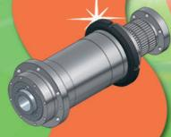
Шпиндель токарного станка с ЧПУ
