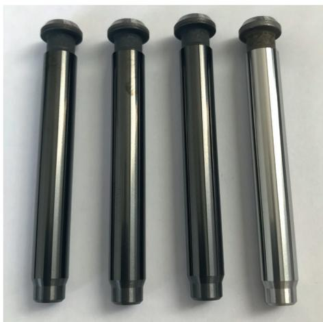
Рис. 12. Плунжеры топливного насоса высокого давления производства АО «ЯЗДА» с покрытием BALINIT<sup>®</sup>DLC — темного оттенка
