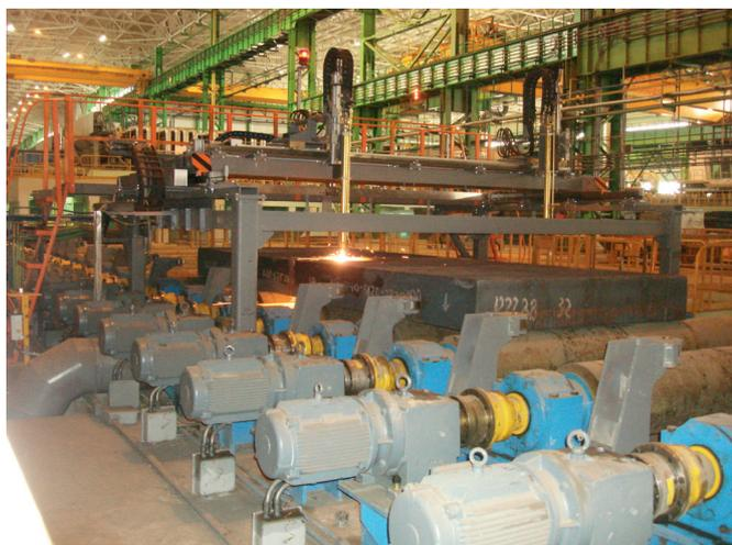
Рис. 1. МГР для кислородной резки слябов
