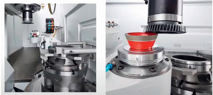
Рис. 10. Скайвинг. Интегрированная технология заточки инструмента. Фото из презентации компании Gleason.
