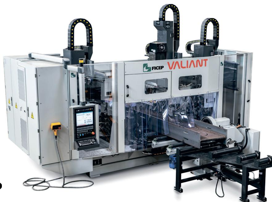
Valiant — это новая сверлильная линия Ficer, способная выполнять сложные высокопроизводительные операции сверления, фрезеровки и гравировки как самостоятельно, так и в комбинации с ленточнопильной машиной или роботом. Эта возможность обеспечивает еще более высокую производительность и сокращает производственный цикл.
