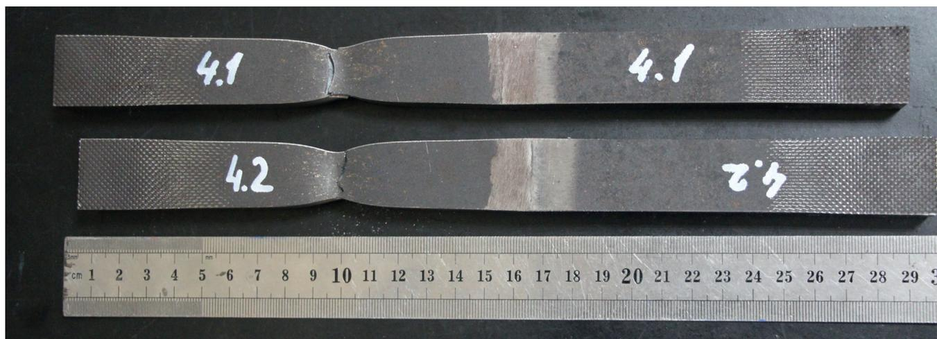
Рис. 8. Результаты испытаний на статическое растяжение стыкового сварного соединения пластин из стали 10Г2ФБЮ (К60) толщиной 16 мм, выполненного гибридной лазерной сваркой
