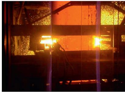
Рис. 3. Резка сляба из высокоуглеродистой стали на УНРС вертикального типа
