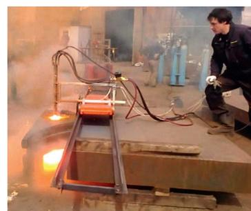
Рис. 11. Переносная машина для кислородно-флюсовой резки «НОРД-500» (применяется для резки слябов на адьюстаже)
