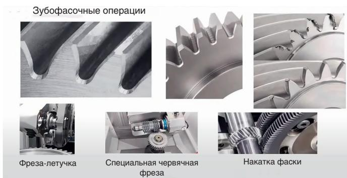
Рис. 8. Зубофасочные операции. Фото из презентации компании Gleason.
