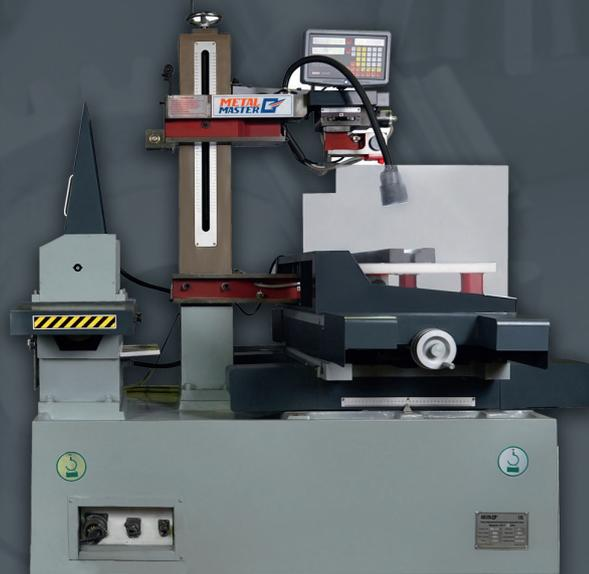
Электроэрозионные проволочно-вырезные станки Metal Master DK77 DRO предназначены для вырезания металлических деталей сложной формы из любых токопроводящих материалов, в том числе, из твердых сплавов, трудно поддающихся механической обработке, способом вырывания частиц с поверхности металла импульсом электрического разряда.
