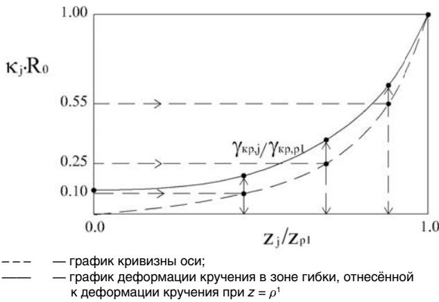
Рис. 6. Изменение кривизны оси трубы и деформации кручения в зоне гибки, где \kappa_j R_0 — обобщённое обозначение дискретных значений (0; 0,1; 0,25; 0,55; 1,00) кривизны изогнутой оси, отнесённой к величине 1/R_0 ; z_{\rho^1} — координата z точки \rho^1 ; z_j — координаты z точек, в которых относительная кривизна изогнутой оси \kappa_j R_0 принимает значения 0; 0,1; 0,25; 0,55; 1,00.
