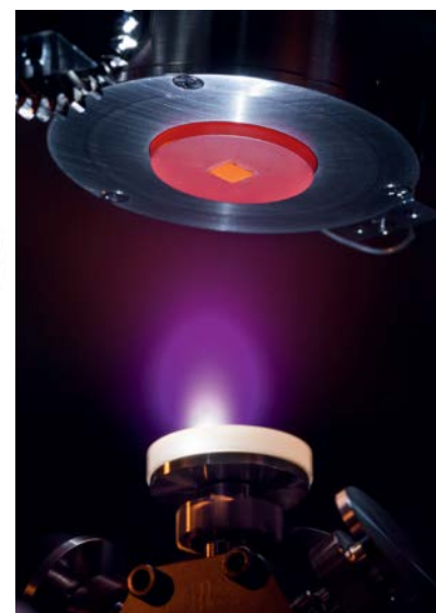
Рис. 12. Технология импульсного лазерного осаждения (PLD) [41]: а) схематическое изображение процесса PLD; б) фотография процесса PLD.
