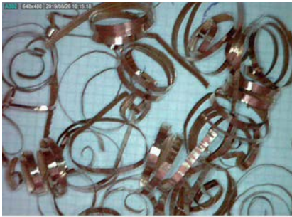
Рис. 4. Формы сливной стружки при пилении БраЖ9-4 Ø220 мм
