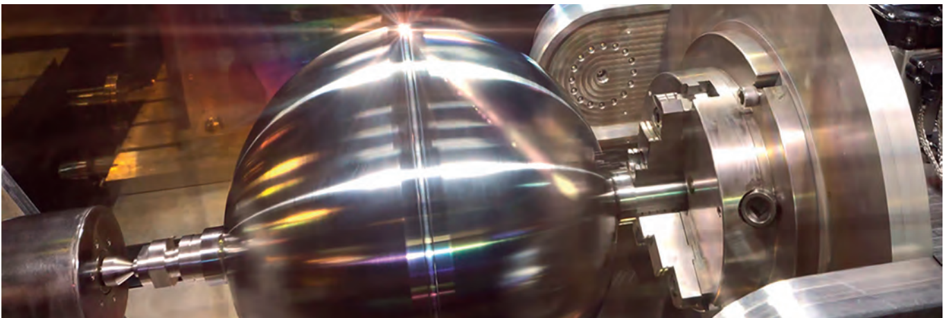
Рис. 8. Производство шар-баллонов: выполнение на одной установке процессов выращивания, механообработки, сварки. Фото: НПФ «TETA»
