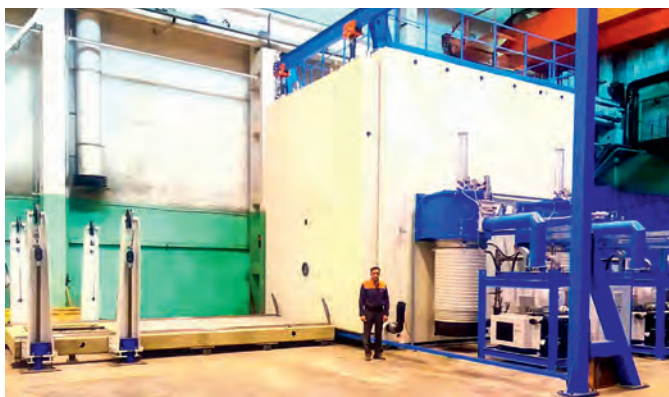
Рис. 5. Установка электронно-лучевой сварки с объемом камеры 160 кубических метров и модуль орбитальной электронно-лучевой сварки. Фото: ОАО НИТИ «Прогресс»
