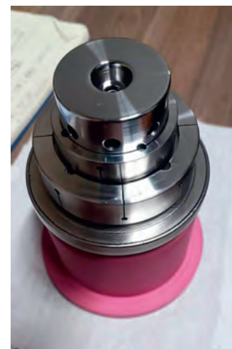
Сварочная электронная пушка с ускоряющим напряжением 60 кВ
