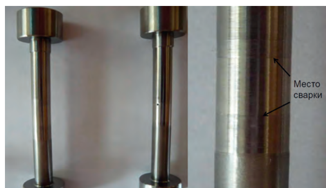
Рис. 3. Диффузионная сварка ВТ8-1 + ЭП 741
