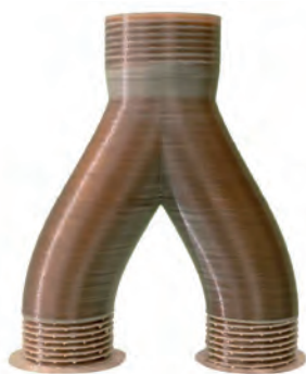
е) элемент патрубка из нейлона с углеволокном (3D-принтер F2 Lite выращивает эту деталь за 3,5 часа). Полученное изделие обладает износостойкостью, термостойкостью, легко поддается постобработке
