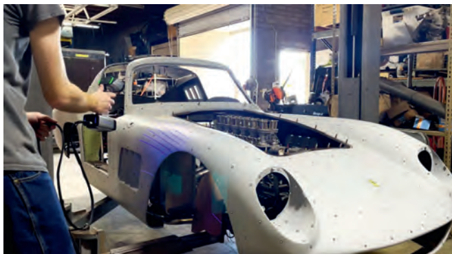
Рис. 15. 3D-сканирование корпуса автомобиля и блока цилиндров
