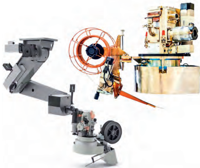
Рис. 6. Модуль аддитивного выращивания. Фото: ОАО «НИТИ «Прогресс»
