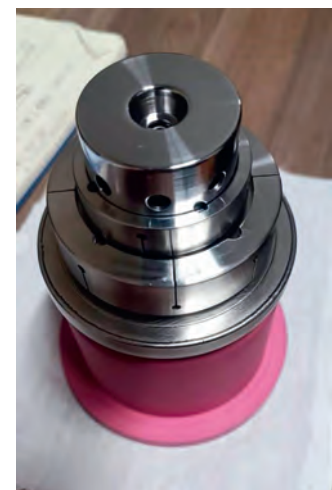
Сварочная электронная пушка с ускоряющим напряжением 60 кВ
