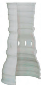
б) корпус двигателя для литья в выплавляемые формы, изготовлен на принтере F2 из материала CAST за 2 часа, устойчив к воздействию ультрафиолета и воздействию большинства органических растворителей
