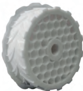
г) прототип колеса из TPU (F2 Lite печатает эту деталь, размером 150x90x150 за 80 минут)
