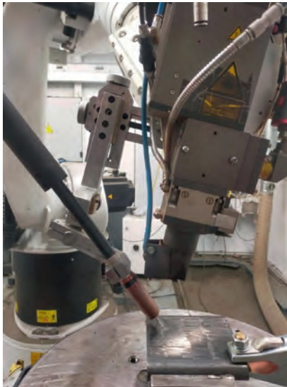
Рис. 6. Роботизированная установка гибридной наплавки. Фото: ООО «Вятское машиностроительное предприятие»
