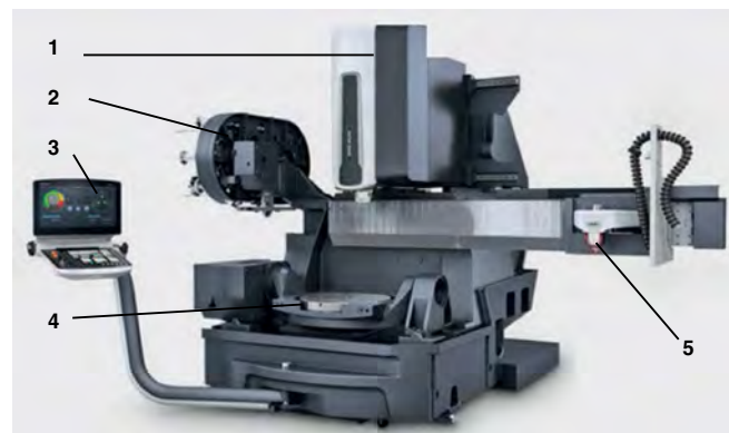
Рис. 3. Общая схема гибридного станка Lasertec 65D: 1 — шпиндельный узел; 2 — инструментальный магазин; 3 — стойка ЧПУ; 4 — координатная система; 5 — лазерный модуль
