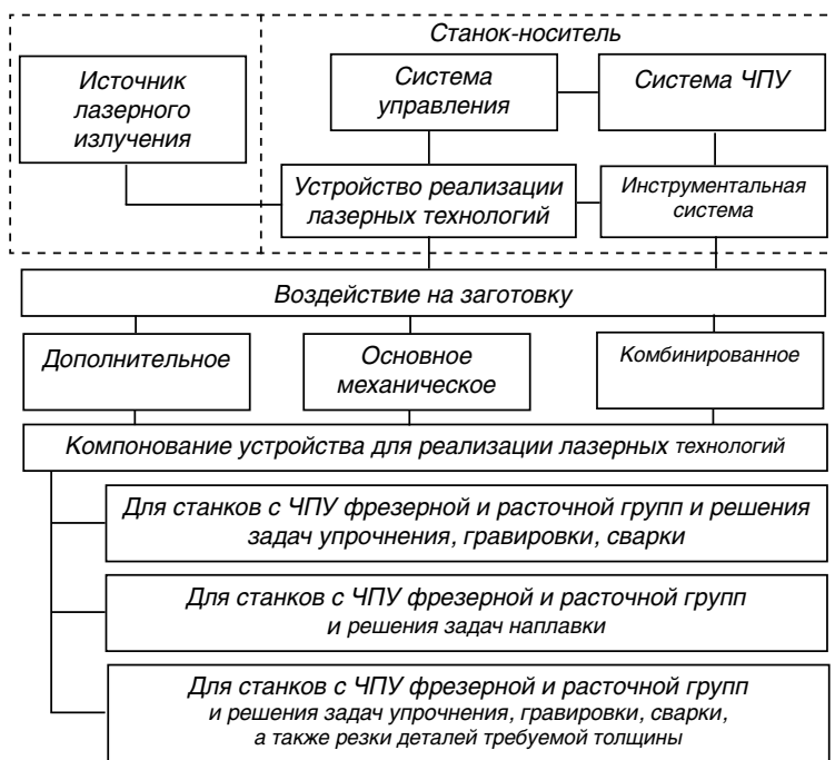
Рис. 7. Блочная-модульная система устройств для реализации технологий лазерной обработки на станках ЧПУ с применением сменных модулей
