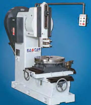
Прецизионный долбежный станок TS-300K
