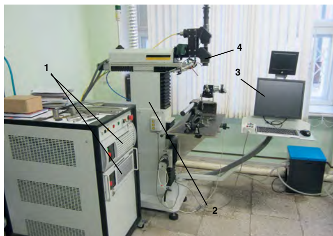
Рис. 2. Стандартный ЛТК (представлена машина производства ГК «Лазеры и аппаратура»): 1 — источник лазерного излучения; 2 — система перемещения по координатным осям; 3 — система ЧПУ; 4 — технологическая головка
