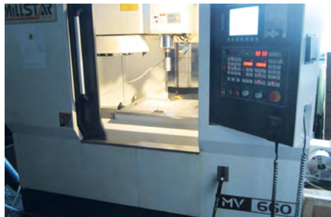
Рис. 9. Станок MILLSTAR MV660 с установленным в шпинделе модулем лазерной маркировки
