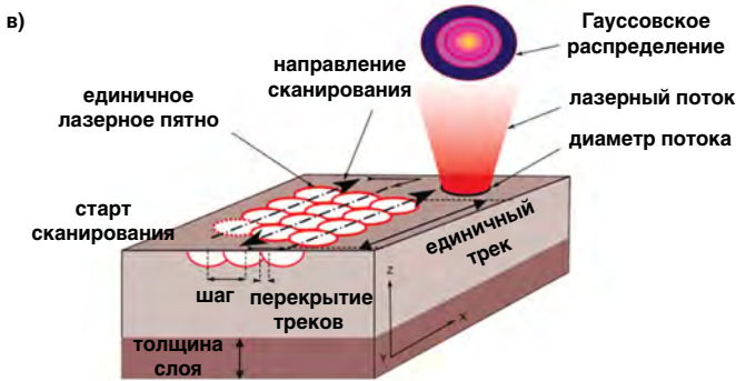
Рис. 1. Схемы процессов ЛП непрерывным (а) и импульсным (б, в) излучением
