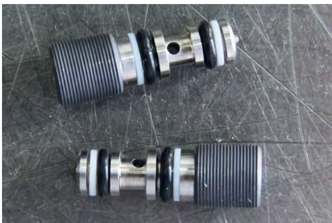
Рис. 2. Прецизионная золотниковая пара агрегата SPOK. Точность обработки до 2 мкм
