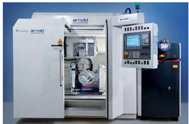
Рис. 12. Станок ALPINE для лазерной полировки пространственно-сложных форм
