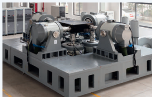
Рис. 4. Использование при испытаниях двух вибростендов
