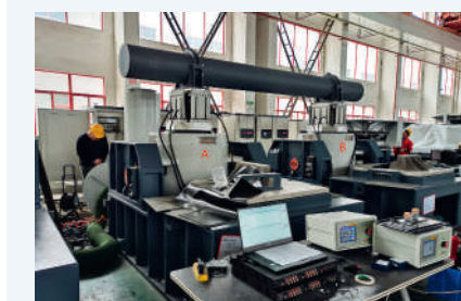
Рис. 3. Модель вертолета на вибростенде
