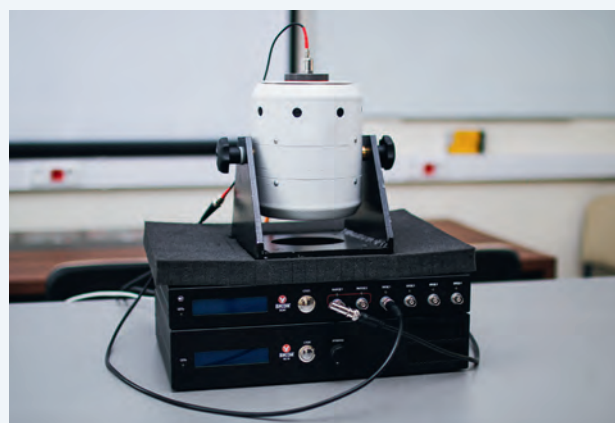
Рис. 8. Небольшой электродинамический вибростенд с подключенным датчиком, контроллер и усилитель
