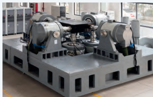
Рис. 4. Использование при испытаниях двух вибростендов
