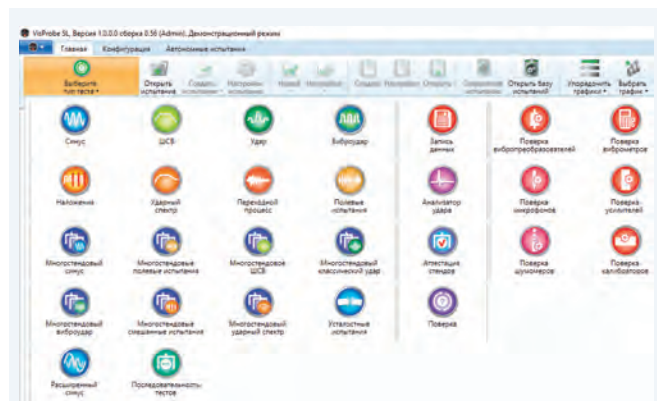
Рис. 1. Пример доступных типов вибрационных испытаний в программе VisProbe SL. Спецификация уточняет, какие именно опции нам пригодятся для работы
