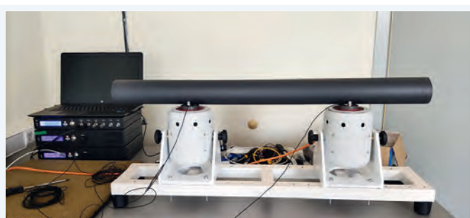
Рис. 4. Использование при испытаниях двух вибростендов
