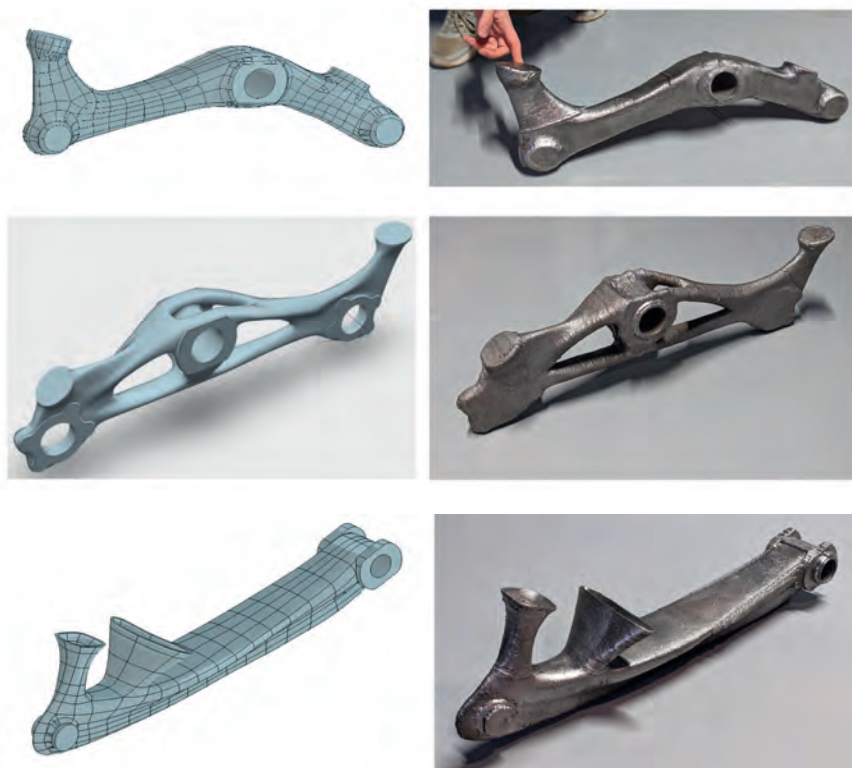
Рис. 4. Выполненные с помощью технологии WAAM сложные пустотелые бионические кронштейны без использования технологических поддержек
