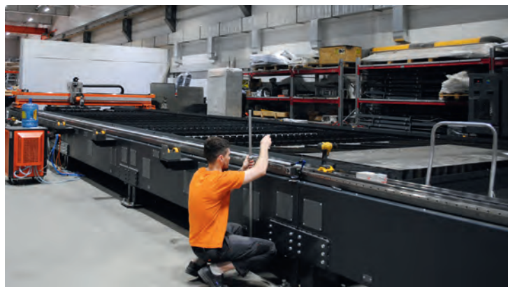
Рис. 5. Производство 12-метрового станка
