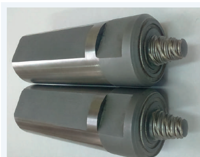
Рис. 26. Сложнопрофильный инструмент для сварки трением-перемешиванием, полученный методом ЭЗФ для сварки алюминиевых сплавов и меди материала толщиной 25...35 мм
