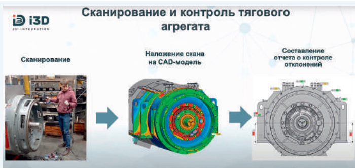
Рис. 15. Применение 3D-сканирования для контроля геометрии. Фото: i3D
