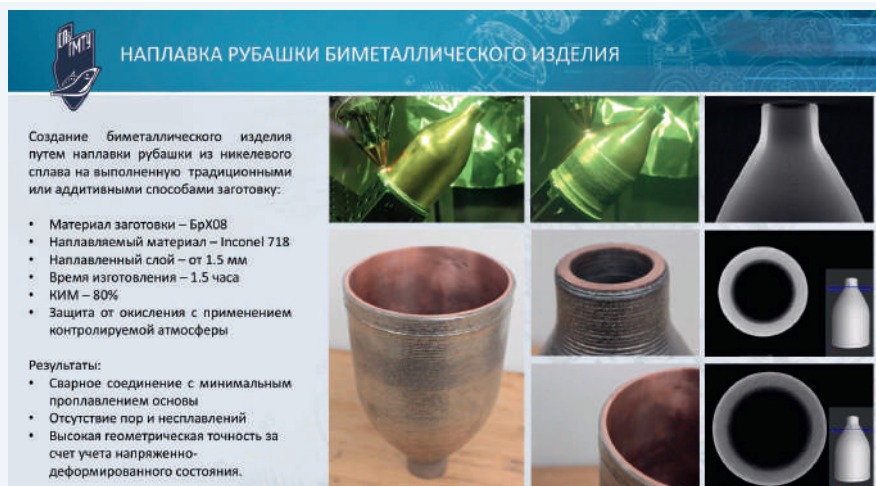
Рис. 2. Создание биметаллического изделия. Фото: ИЛИСТ СПбГМТУ
