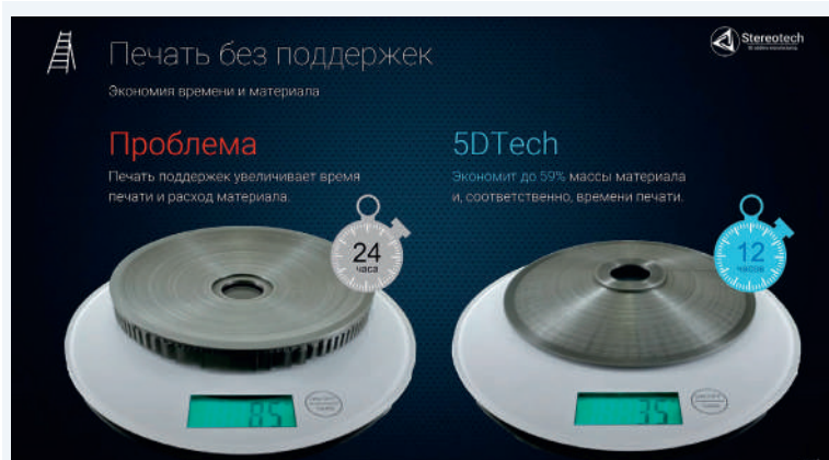
Рис. 9. Печать без поддержек по технологии 5Dtech. Фото: ООО «Стереотек»
