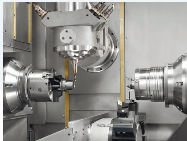
Рис. 15. Широко известные схемы организации рабочей зоны многофункциональных станков
