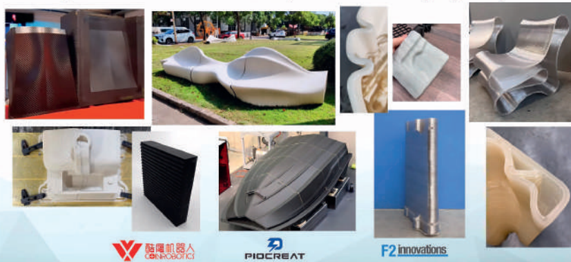
Рис. 12. Изделия, напечатанные из ПКМ. Фото: i3D
