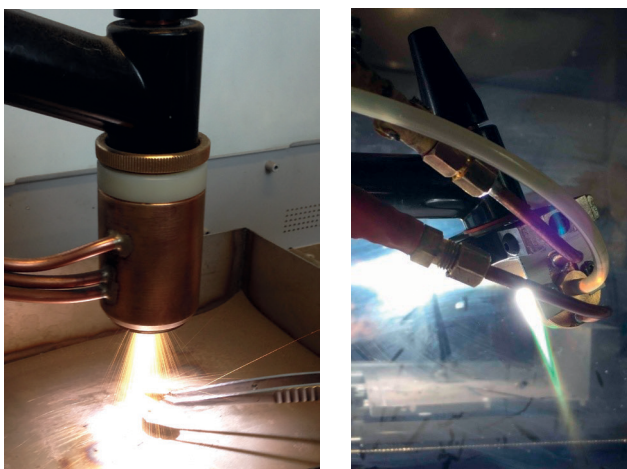
а) Рис. 3. Вид плазматронов с аксиальным вводом порошка (а) и вынесенным анодом (б)
