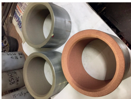
Рис. 11. Детали подшипников скольжения с покрытием из бронзы ПР-БрАЖМц 8,5-4-5-1,5 и меди М1
