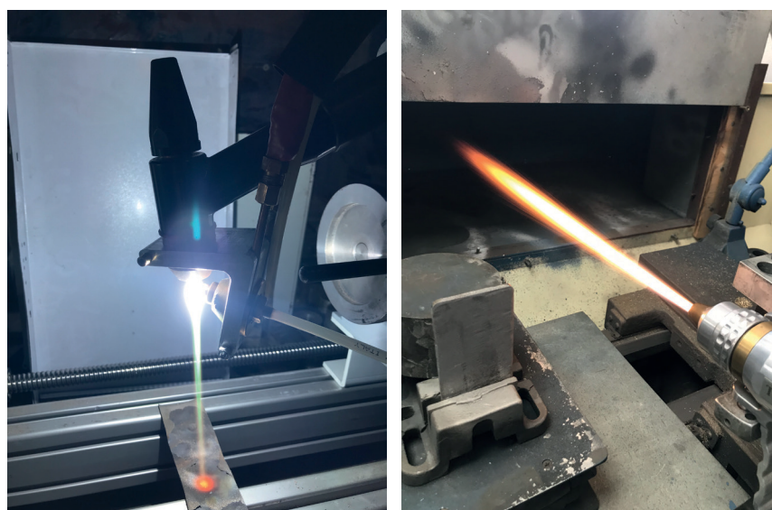
Рис. 7. Вид плазменной струи при МПН (а) и газового пламени при HVOF (б)
