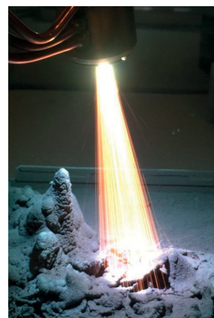
Рис. 5. Вид плазменной струи при МПН металлического порошка плазматроном с аксиальным вводом
