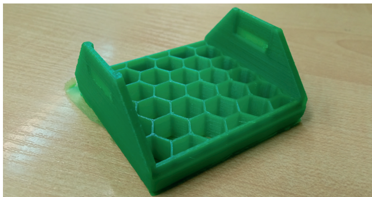
Рис. 4. Держатель монокуляра (состоит из трех деталей — основы и двух «ушей»)
