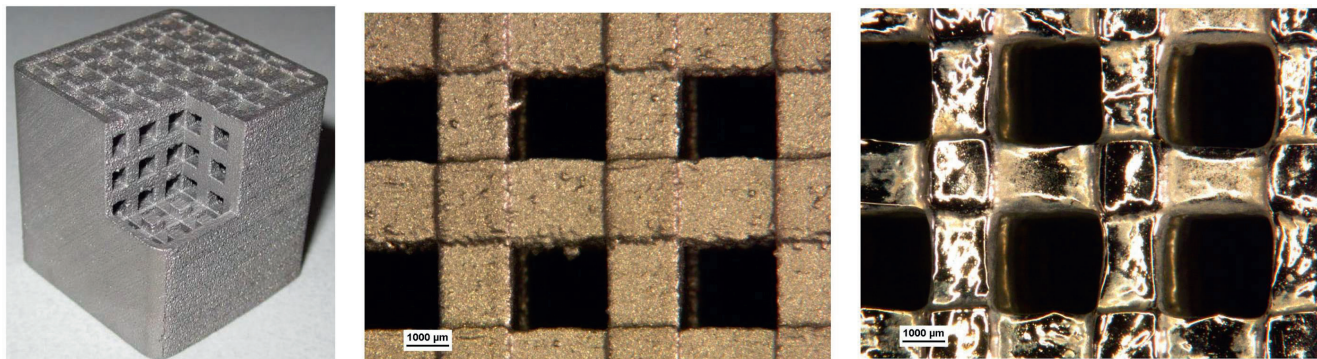
Рис. 4. Решетчатая структура после построения и очистки (а), внутренняя поверхность до (б) и после (в) ЭХО
