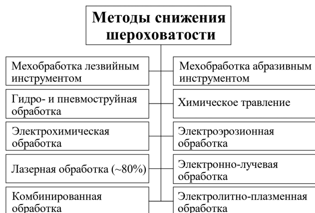
Рис. 1. Основные методы и технологии дополнительной обработки заготовок АП
