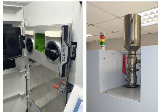
Рис. 4. Перчаточный модуль и модуль загрузки МПК установки ULS-125
