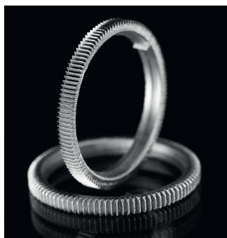
Рис. 10. SLM-печать: 1 – сетка для пищевой промышленности, 2 – зубчатые колеса. Фото: 3D Lam.
