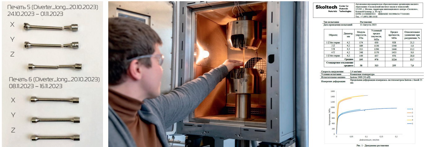
Рис. 5. Процедура контроля механических характеристик напечатанного материала методом разрушающего контроля образцов-свидетелей
