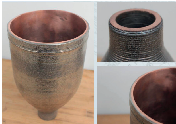
Рис. 7. Создание биметаллического изделия путем наплавки рубашки из никелевого сплава на выполненную традиционными или аддитивными способами заготовку. Фото: ИЛИСТ
