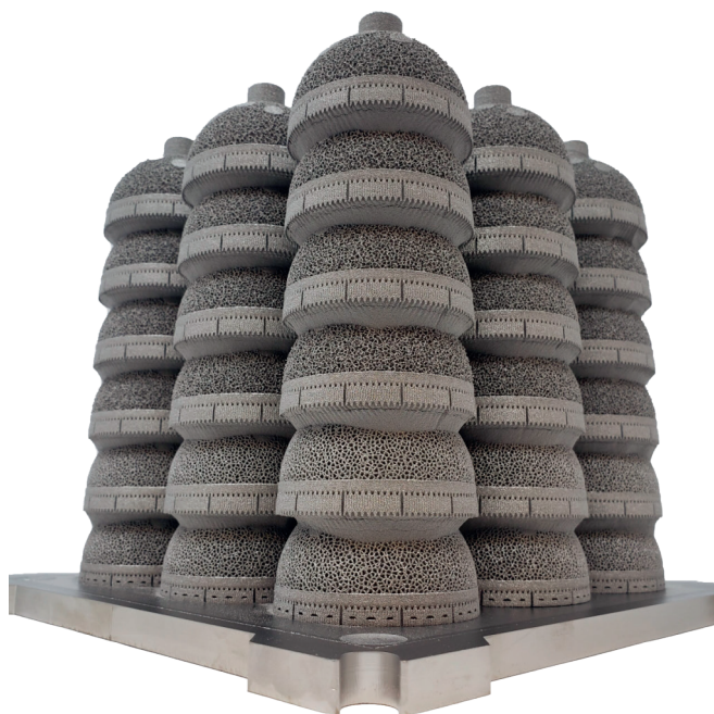
Рис. 2. Серийное производство 54 ацетабулярных чаш для эндопротезирования тазобедренного сустава по технологии E-PBF (изображение предоставлено General Electric, Inc., США)
