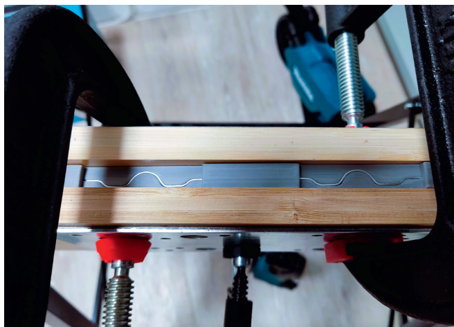
Рис. 3. Процесс штамповки штампами из PLA-пластика с помощью винтовых струбцин и готовой детали
