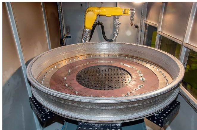
Рис. 8. Кольцо наружное от двигателя ПД-14: максимальный диаметр 2070 мм, высота 250 мм, порошок ВТ-6, масса наплавленного материала 86 кг. КИМ – более 70%, время выращивания 128 часов. Фото: ИЛИСТ
